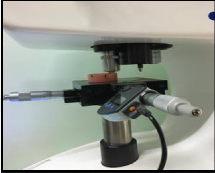
Resim 11. Hazırlanan mine örneklerinin mikrosertlik değerlerinin ölçümü.
