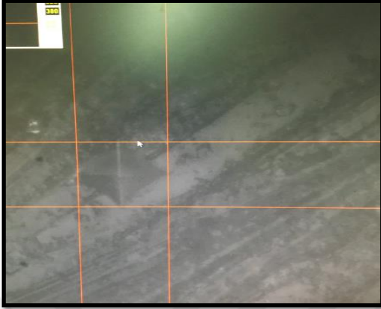
Resim 12. Vickers mikrosertlik cihazının izi ve sertlik ölçümü.
