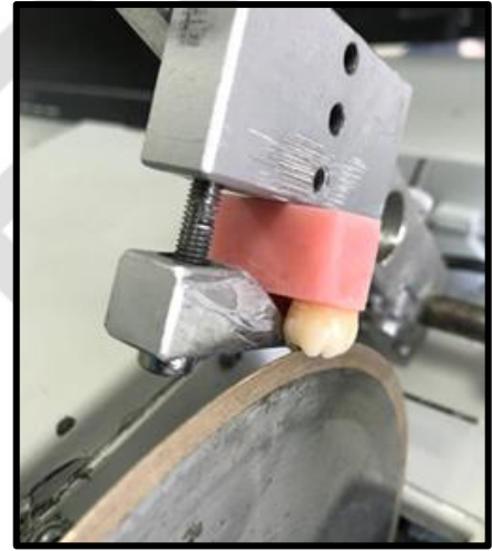
Resim 2. Dişlerin elmas separe ile meziodistal yönde kesilmesi
