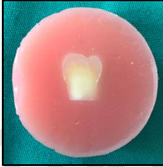
Resim 4. Otopolimerizan akrilik rezine gömülen dentin örneği
