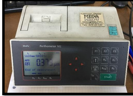
Resim 23. Çalışmamızda kullanılan profilometre cihazı
