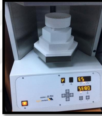
Resim 7. Sinterleme fırınına yerleştirilmiş zirkonya örnekler
