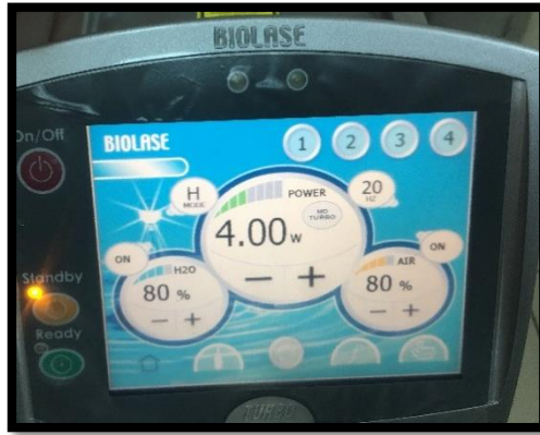
Resim 14. Dördüncü grupta Er, Cr: YsGG lazerin zirkonya örneklerin yüzeylerine uygulanan parametreleri
