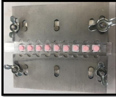
Resim 33. Üzerine veneer seramiği tepilen örneklerin kalıp içerisinde çıkarılması
