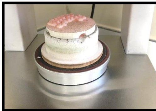
Resim 35. Hazırlanan örneklerin seramik fırınında pişirilmesi
