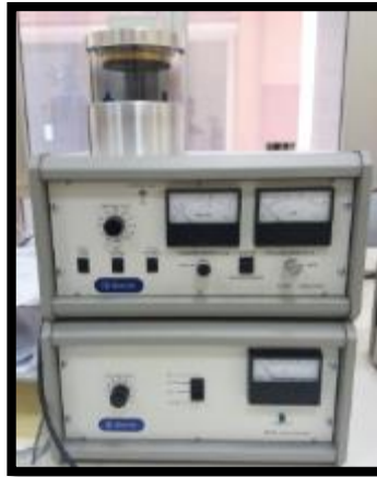
Resim 25. Çalışmamızda kullanılan altın kaplama cihazı
