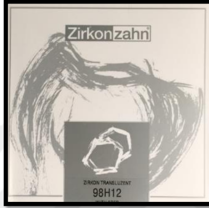
Resim 1. Zirkonya örneklerin üretildiği yarı sinterize zirkonya blok
