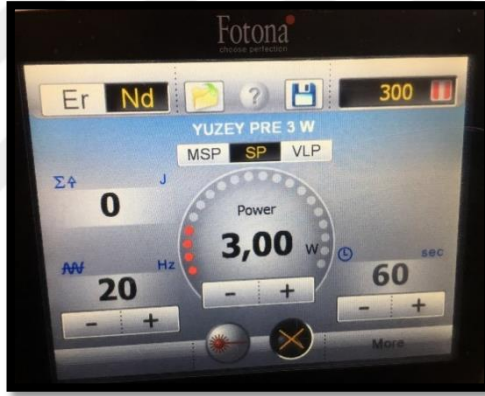
Resim 18. Altıncı grupta Nd: YAG lazerin zirkonya örneklerin yüzeylerine uygulanan parametreleri
