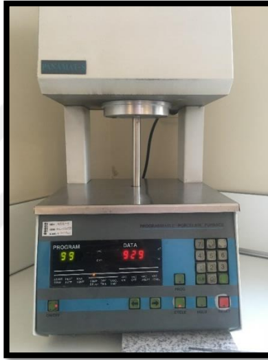
Resim 34. Çalışmamızda kullanılan seramik fırını
