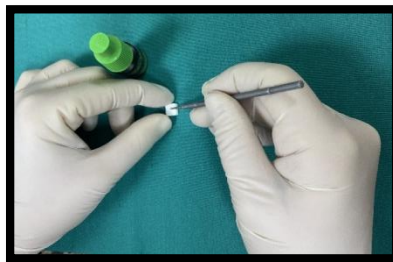
Resim 28. Zirkonya örnekler metal primer uygulanması
