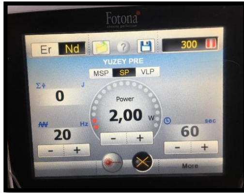
Resim 16. Beşinci grupta Nd: YAG lazerin zirkonya örneklerin yüzeylerine uygulanan parametreleri
