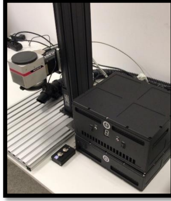
Resim 19. Çalışmamızda kullanılan ultrahızlı fiber lazer cihazının görüntüsü
