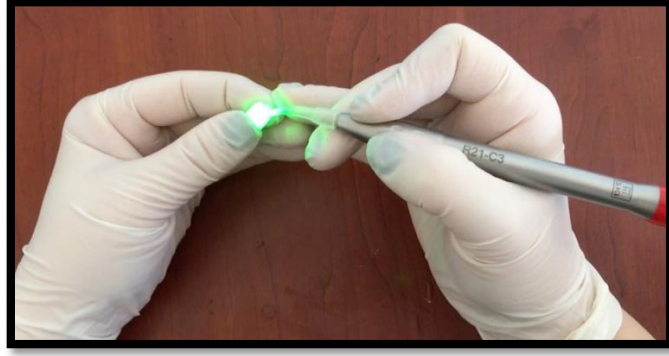
Resim 17. Zirkonya örneklere Nd: YAG lazerin uygulanması
