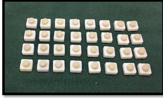
Resim 36. Veneer seramiği uygulanmış zirkonya örnekler
