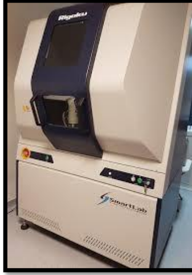
Resim 24. Çalışmamızda kullanılan X Ray Difraktometre cihazı
