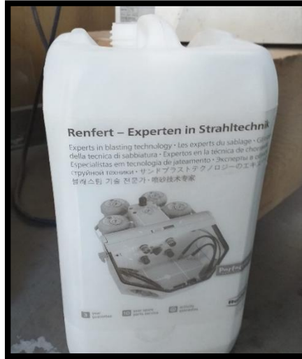
Resim 9. Çalışmamızda kullanılan 125\ \mu\text{m} \text{Al}_2\text{O}_3 kum
