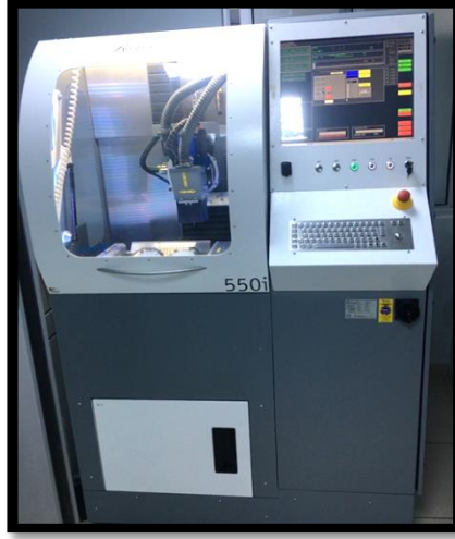
Resim 3. Zirkonya örneklerin hazırlanmasında kullanılan CAD-CAM cihazı (imes- icore Coritec 550i, Almanya)
