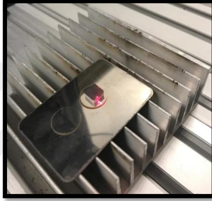
Resim 20. Ultrahızlı fiber lazerin zirkonya örneklerine uygulanması
