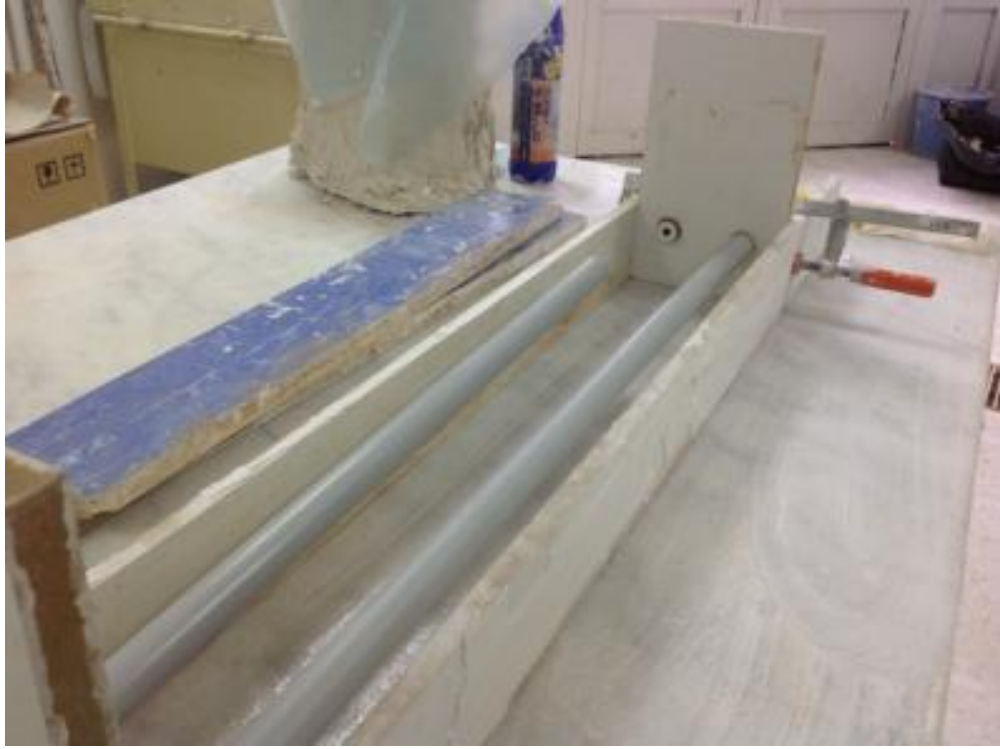
Resim 4.41 Boru kalıplarının alınma aşaması
