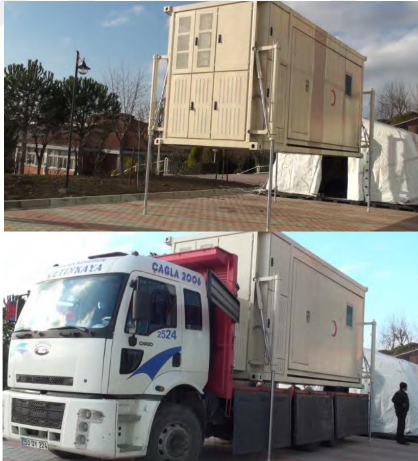
Resim 33: Sağlık Ünitesinde Kullanılan Teleskopik Ayak Sistemi ve Tır Aracına Yüklenmesi Kaynak: http://www.turmaks.com.tr
