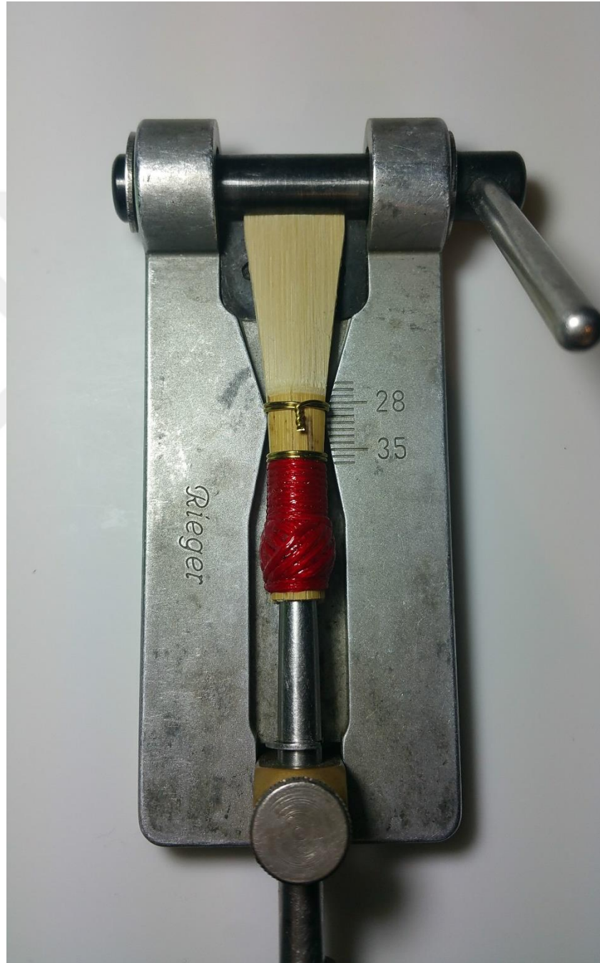
Şekil 19 Ucu 27mm kesilen fagot kamış.
