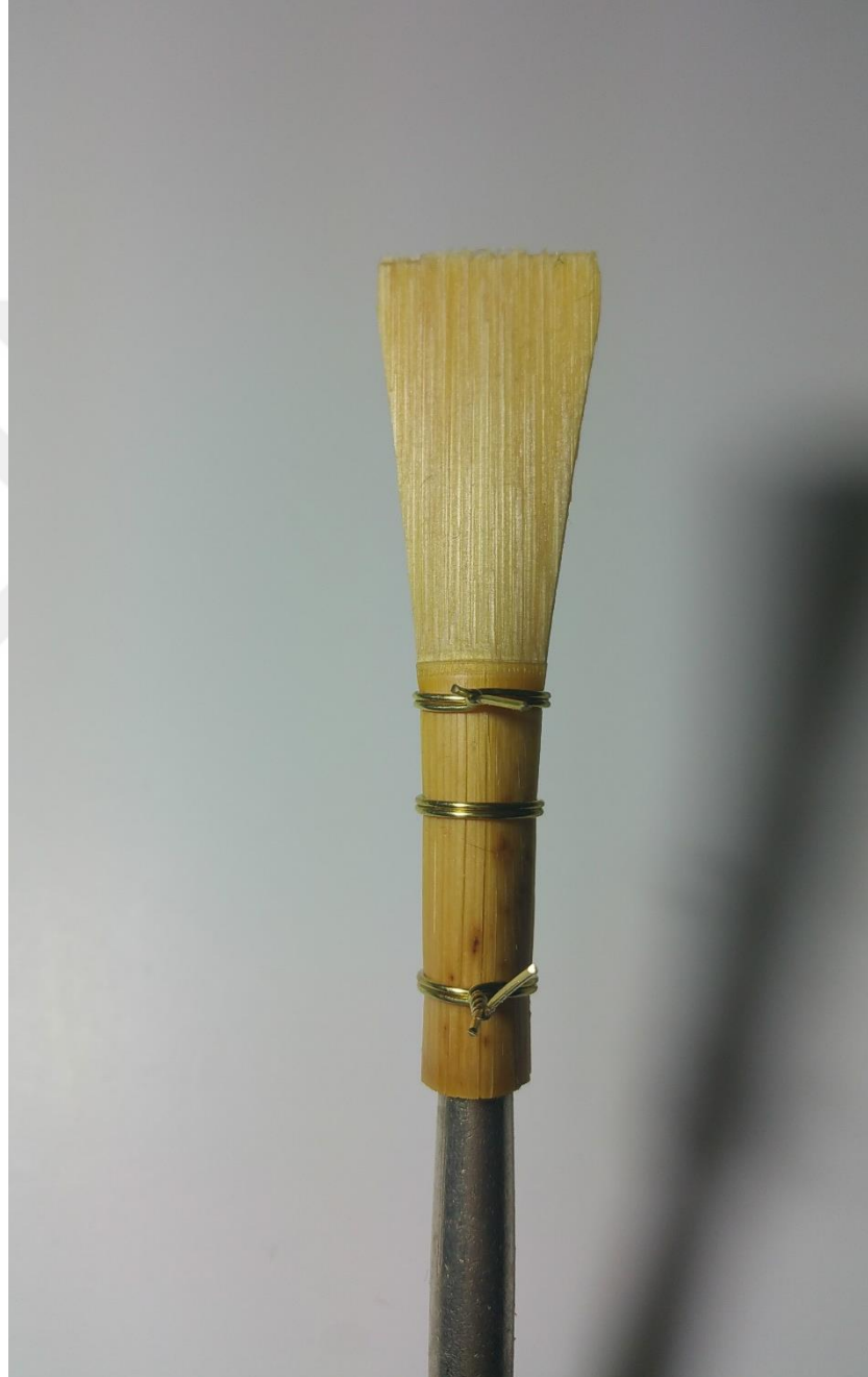
Şekil 16 Arkası yuvarlak form verilmiş ve 3 adet pirinç tel yardımı ile sabitlenmiş kargı.
