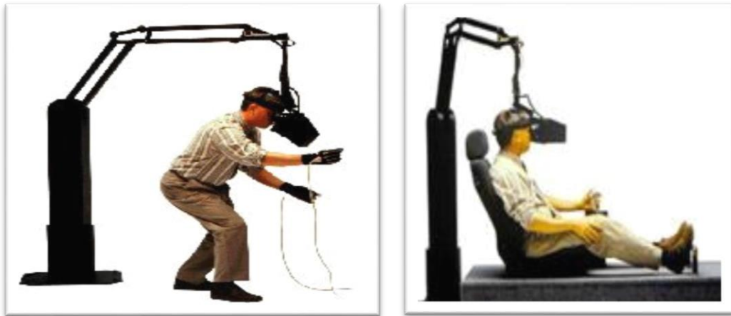
Görüntü 8: Mekânîk izleme aygıtı örnekleri
