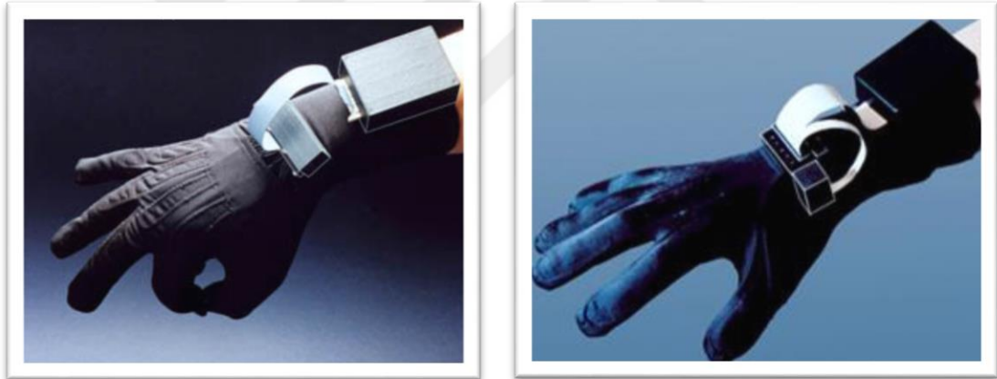
Görüntü 22: Veri eldivenine yerleştirilen elektromanyetik izleme aygıtları
