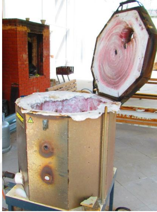
Resim 2.5: Kasinasyon işleminin yapıldığı gazlı fırın
