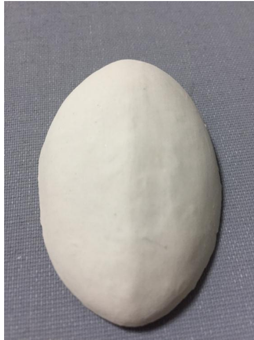
Resim 2.28: 1250°C de pişirilmiş deneme
