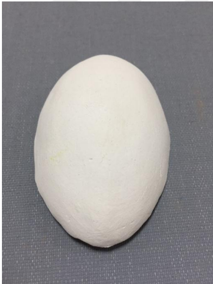
Resim 2.9: 1050°C de pişirilmiş deneme
