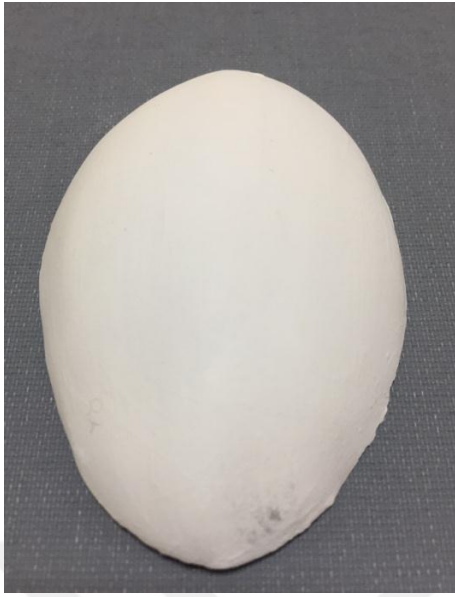
Resim 2.11: 1150°C de pişirilmiş deneme
