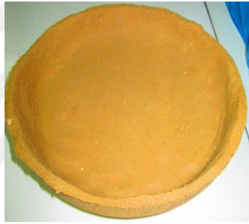
Resim 2.2: Kalsinasyon için hazırlanmış kuru şamot kap
