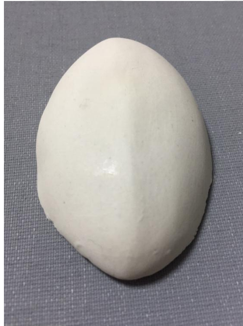
Resim 2.18: 1250°C de pişirilmiş deneme
