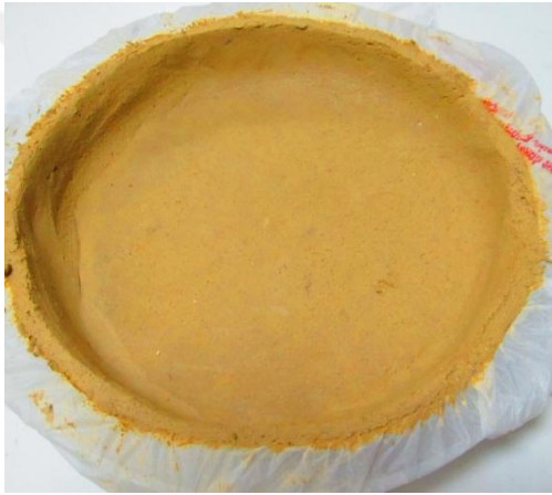
Resim 2.1: Kalsinasyon için hazırlanmış yaş şamot kap
