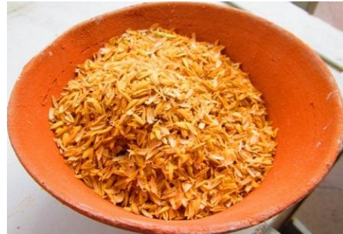
Resim 2.4: Pirinç kabuklarının kalsinasyona hazırlanması.
