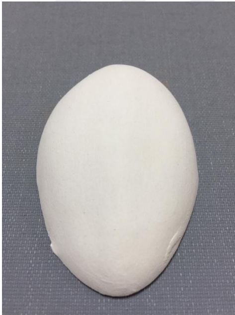
Resim 2.14: 1050°C de pişirilmiş deneme
