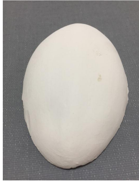
Resim 2.10: 1100°C de pişirilmiş deneme
