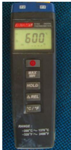
Resim 2.6: Sıcaklık ölçümünde kullanılan ısı ölçer (termokupl)
