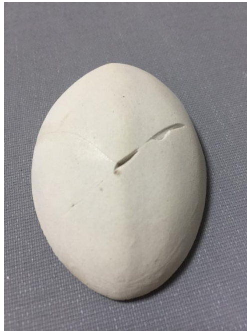
Resim 2.68: 1250°C de pişirilmiş deneme
