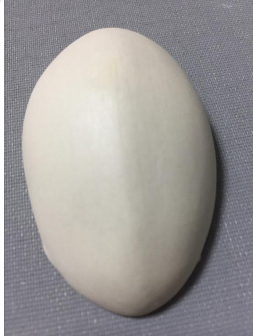
Resim 2.53: 1250°C de pişirilmiş deneme
