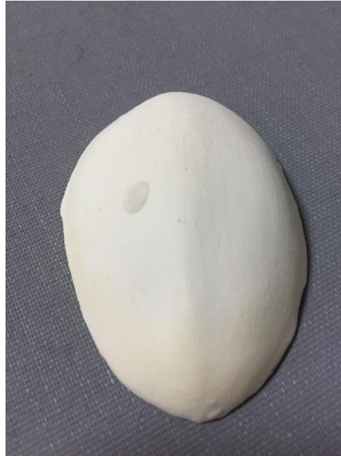
Resim 2.33: 1250°C de pişirilmiş deneme
