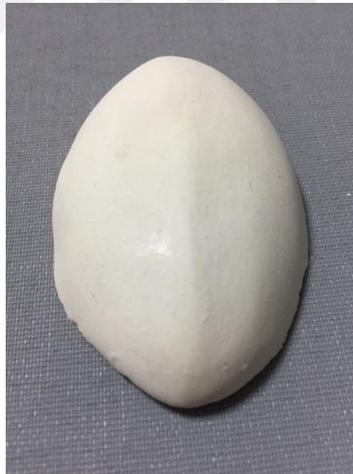
Resim 2.13: 1250°C de pişirilmiş deneme
