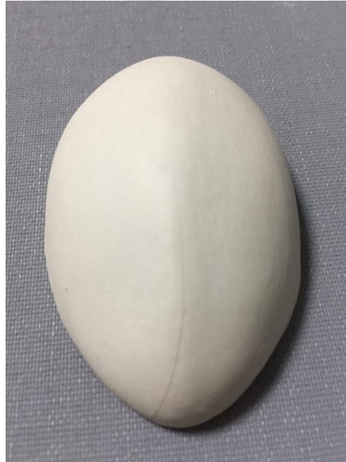
Resim 2.43: 1250°C de pişirilmiş deneme
