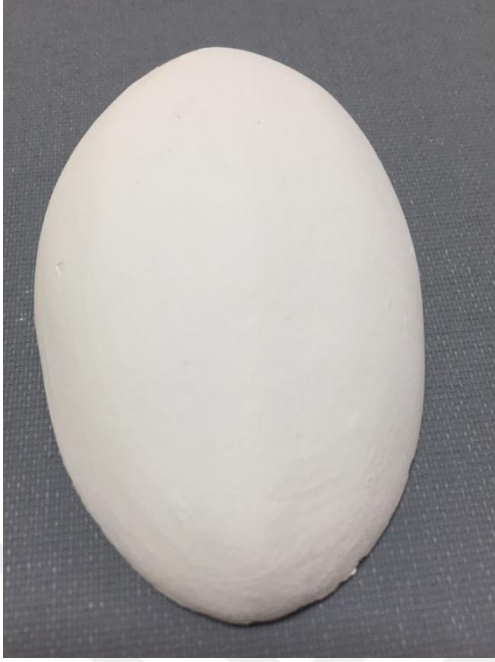
Resim 2.26: 1150°C de pişirilmiş deneme
