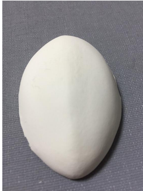
Resim 2.38: 1250°C de pişirilmiş deneme
