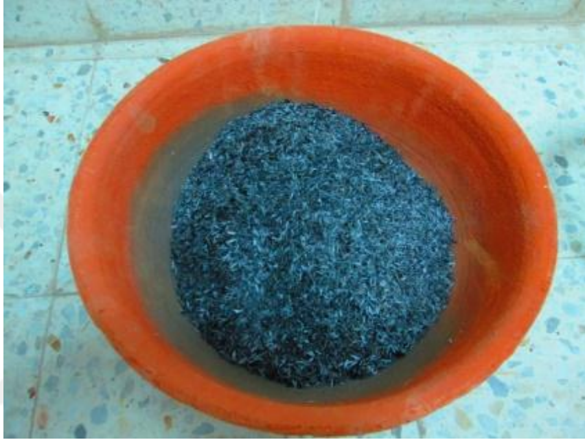
Resim 2.7: Kalsinasyon sonrası pirinç kabuklarının görünümü
