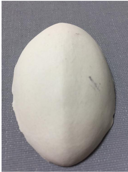
Resim 2.23: 1250°C de pişirilmiş deneme
