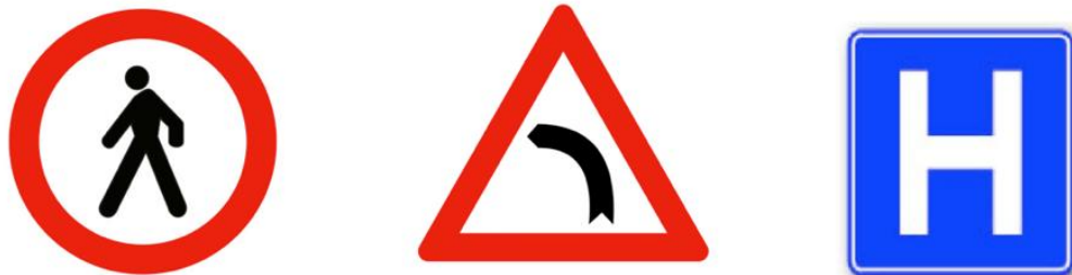
Görüntü 100: Sırasıyla yasaklama, uyarı ve bilgilendirme ifade eden trafik işaretlerinden bir görüntü ( http://tayehliyet.com/ders-slaytlari-2/ ).
