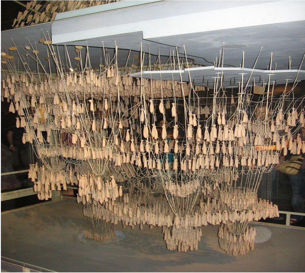
Görsel 53. Sagrada Di Famiglia'nın parametrik hesaplamalar ile tasarlanmış zinciri Elektronik Kaynak: http://www.todocalidad.es/barcelona-la-sagrada-familia/ Son Erişim: 05/09/2017
