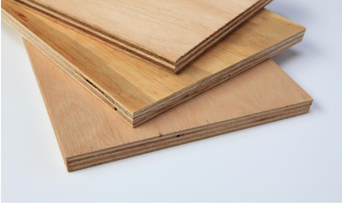
Görsel 6.103: Panellerin ana malzemesini oluşturan, suya ve ateşe dayanıklı su kontrplağı. Kaynak: http://www.wipltd.in/plywood.php Son Erişim:05/09/2017
