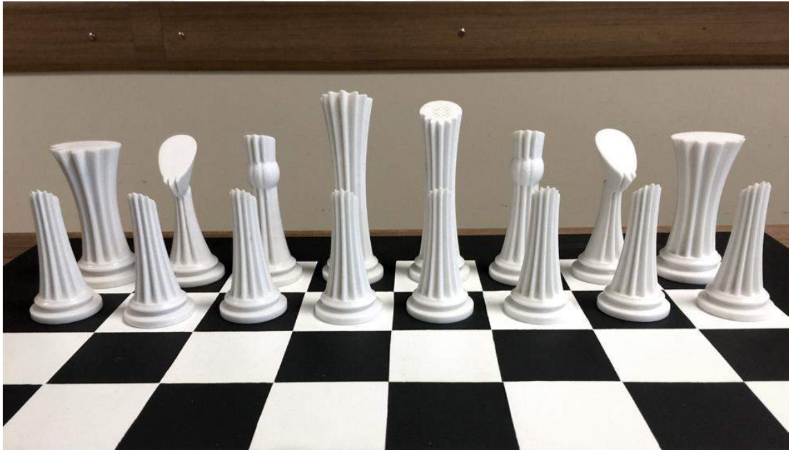
Görüntü 70: 3Ds Max Yazılımıyla modellenmiş satranç taşlarının 3 boyutlu yazıcı ile üretilmiş seramik taşları. (Tasarım: Hüseyin Baran)
