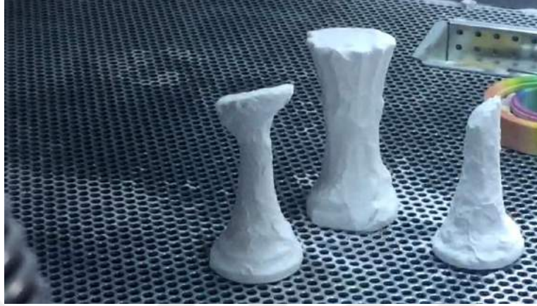
Görüntü 69: 3Ds Max yazılımıyla 3 boyutlu olarak modellenmiş satranç taşlarının 3 Boyutlu yazıcıdan çıktı alındıktan sonra seramik tozu içerisinde henüz çıkarılmış görüntüleri. (3D Model ve Seramik 3D Çıktı: Hüseyin Baran)
