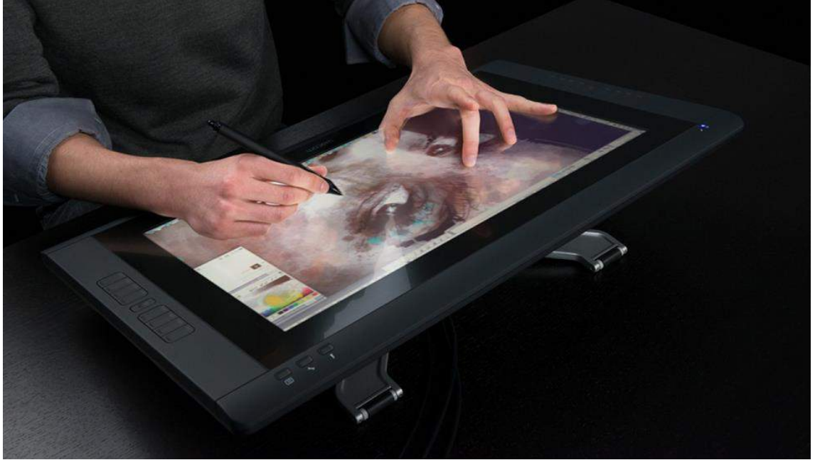
Görüntü 63: Tasarımcının çizimlerini direkt olarak, bu iş için tasarlanmış basınca duyarlı bir ekran üzerine yaptığı özel bir grafik tablet ve dijital kalem.
