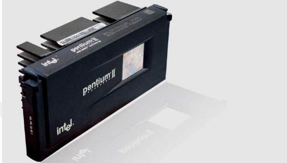
Görüntü 52: MMX teknolojisi ile Pentium II işlemci ve SECC kartuş.
