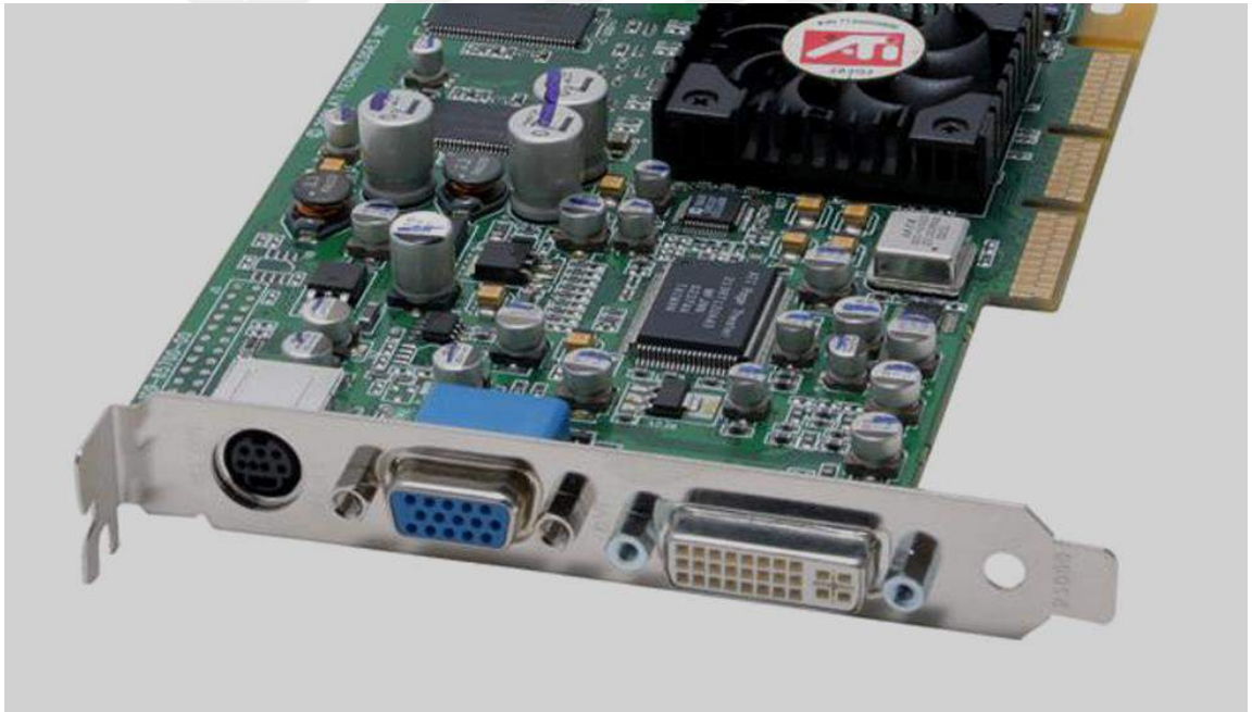
Görüntü 55: Video Graphics Array (VGA) bağlantılı ekran kartı.
