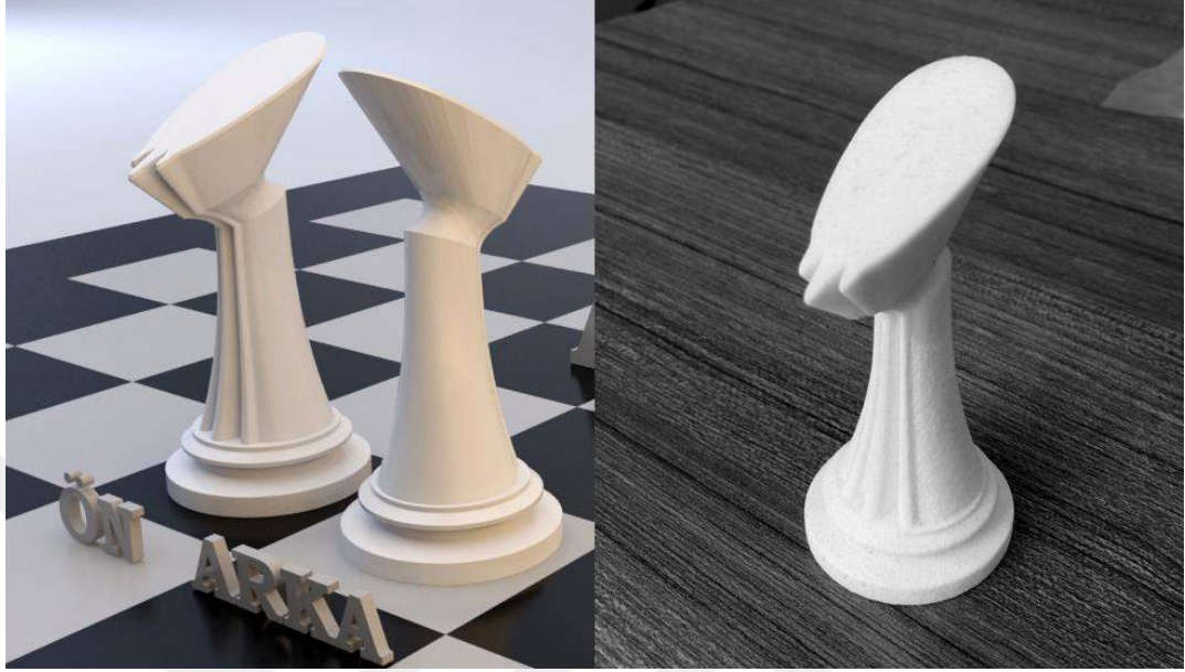
Görüntü 72: Satranç taşı stylize at figürünün 3Ds Max yazılımında modellenmiş görüntüsünün jpg formatında render çıktısı ve figürün 3 boyutlu yazıcıdan seramik çıktı alınmış son hali. (3D Render ve 3D Çıktı: Hüseyin Baran)
