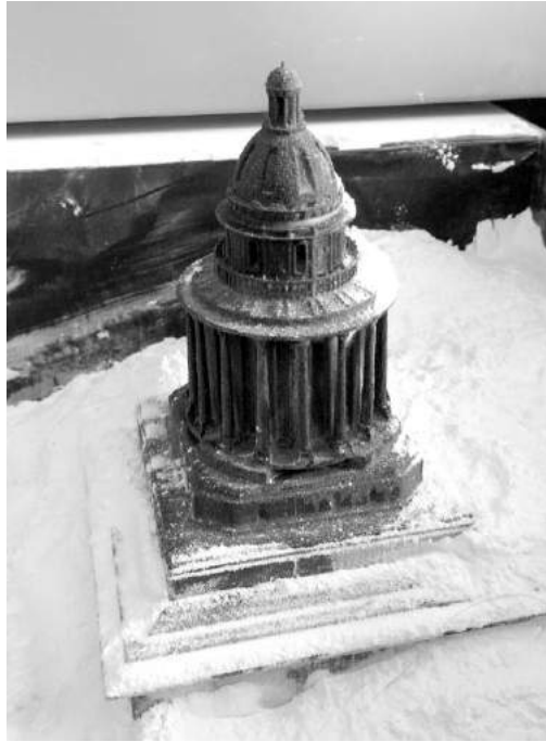
Görüntü 106: Üç boyutlu modellemenin 3D yazıcıdan seramik çıktı alınırken, çıktı işlemi tamamlanan yapının toz seramik içerisinde alınma öncesini gösteren resim. (3D Model: Hüseyin Baran)
