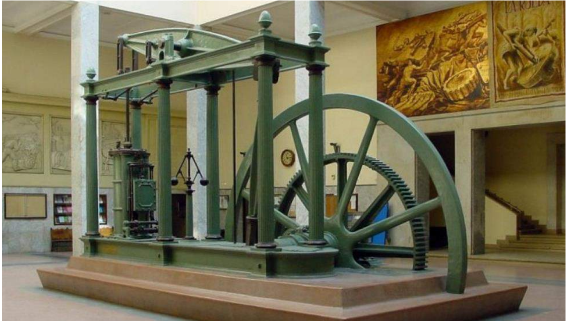
Grnt 32: Sanayi Devrimi'nin simgelerinden olan Watt tipi buharlı makinenin 1859'da Napier ve Son tarafından yaptırılan kiriř motoru rneđi.
