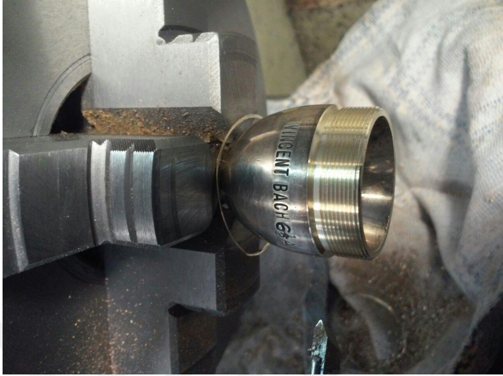
Resim 9. Uygulamada çerçevesi kesilerek yiv açılan ağızlık
