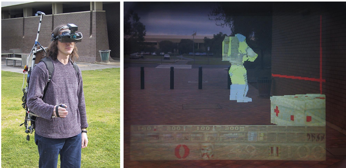
Görüntü 4, ARQuake oyunu için tasarlanan taşınabilir donanım (solda) ve HMD içinden oyuncunun gördüğü birleştirilmiş görüntü (Piekariski ve Thomas, 2002)
