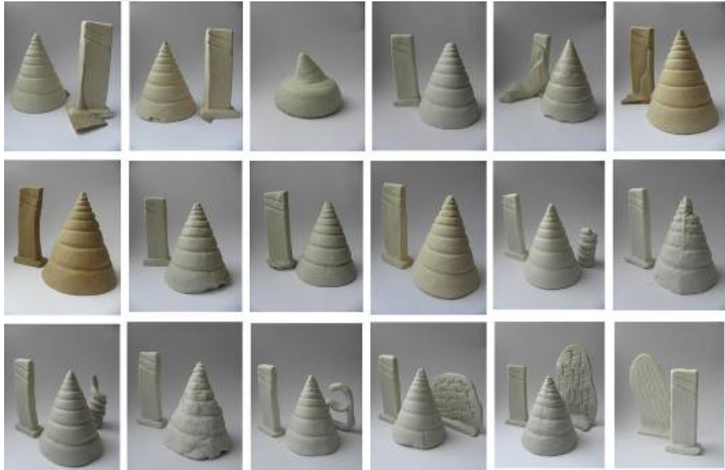
Resim 57: Açık Yeşil Porselen Bünye Araştırmaları İçin Oluşturulan 22 Adet Porselen Harmanı Denemelerinin Bir Kısım Görünümü.
