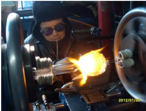
Görsel 80: E. Arda, cam tornasında şekillendirme (Fotoğraf kişisel arşiv)
