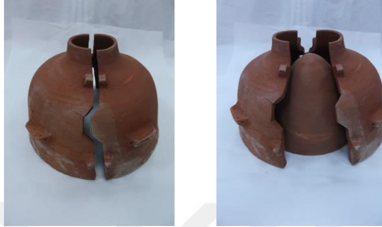
Görsel 106: İki parça kilitli, kulplu üç boyutlu cam kalıbı (Fotoğraf kişisel arşiv)
