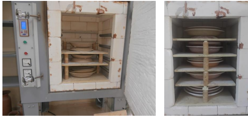
Görsel 112: Tabak kalıpların fırınlanması (Fotoğraf kişisel arşiv)
