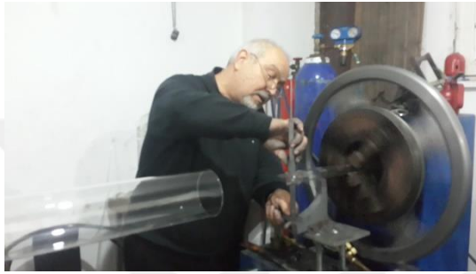
Görsel 47: Grafit kılavuz ile cam boru arasının ölçümü ve grafit ile cam boru mesafesinin ayarlanması (Fotoğraf kişisel arşiv)
