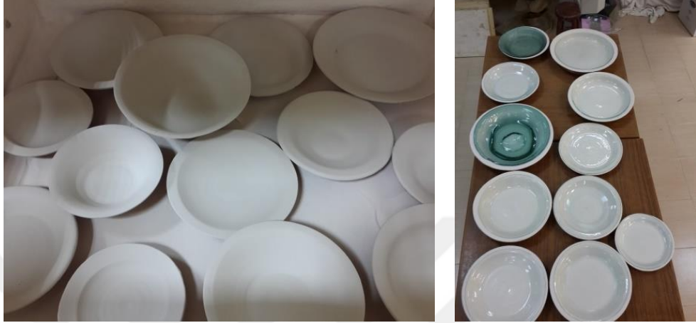
Görsel 116: Astarlanmış pişmiş seramik kalıplar ve çökertilmiş camlar (Fotoğraf kişisel arşiv)
