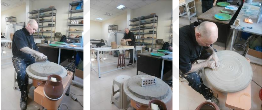
Görsel 94: Kilin yüzeye yayılması ve perdanlanması yapılır (Fotoğraf kişisel arşiv)
