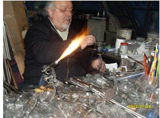
Görsel 81: Açık alevle şekillendirme ile kap ve sap kısımların montajı (Fotoğraf kişisel arşiv)
