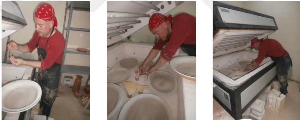
Görsel 115: Seramik cam tabak kalıpların füzyon cam fırınına yerleştirilmesi (Fotoğraflar Serpil Aksüt)
