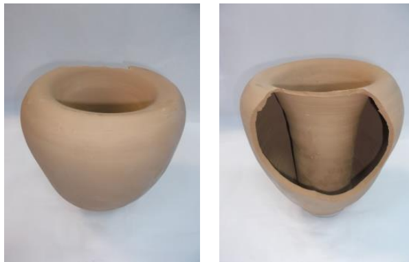
Görsel 103: Çömlekçi çarkında şekillendirilmiş yekpare çift cidarlı cam kalıbı (Fotoğraf kişisel arşiv)
