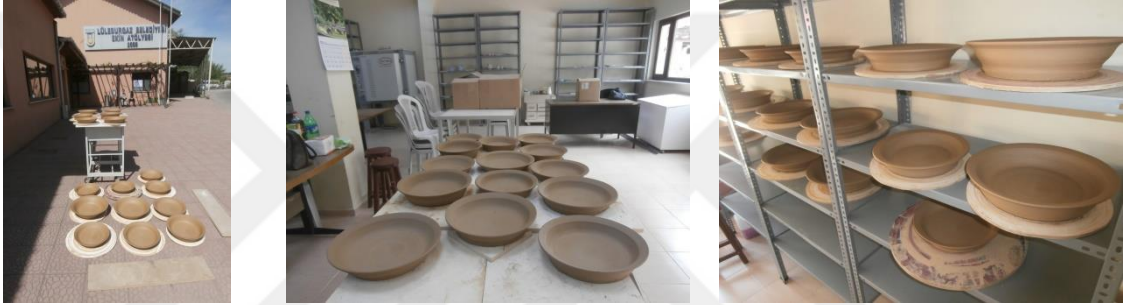
Görsel 111: Güneşte ve atölye ortamında tavlama (Fotoğraf kişisel arşiv)
