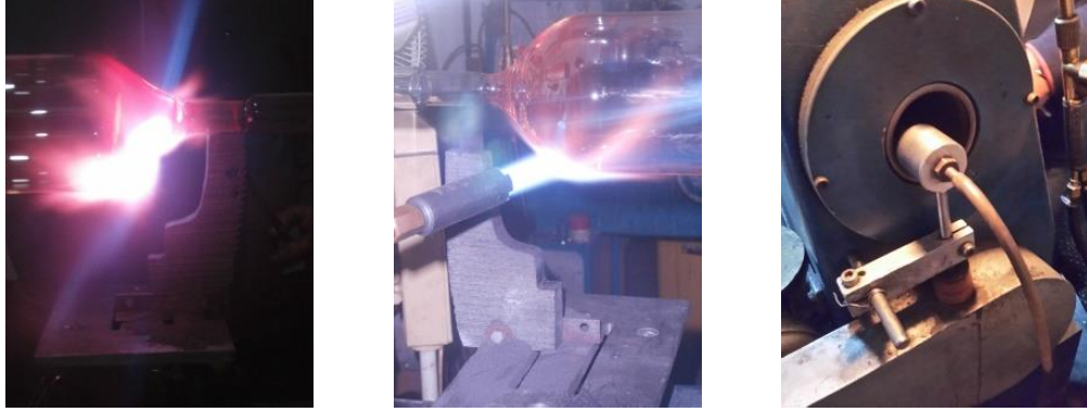
Görsel 49: İki cam borunun bütünleşmiş hali ve ince kauçuk hortum (Fotoğraf kişisel arşiv)
