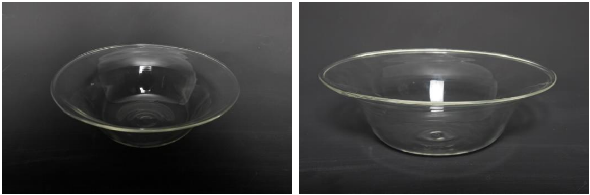
Görsel 62: Cam tornada şekillendirilmiş borosilikat cam tabak, çap 32cm, yükseklik 6cm (Fotoğraf Tuncay Alpi)
