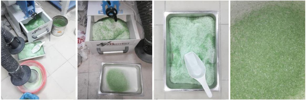
Görsel 130: Kırılmış camın elekten geçirilmesi ve tane iriliklerinin eşitlenmesi (Fotoğraf kişisel arşiv)
