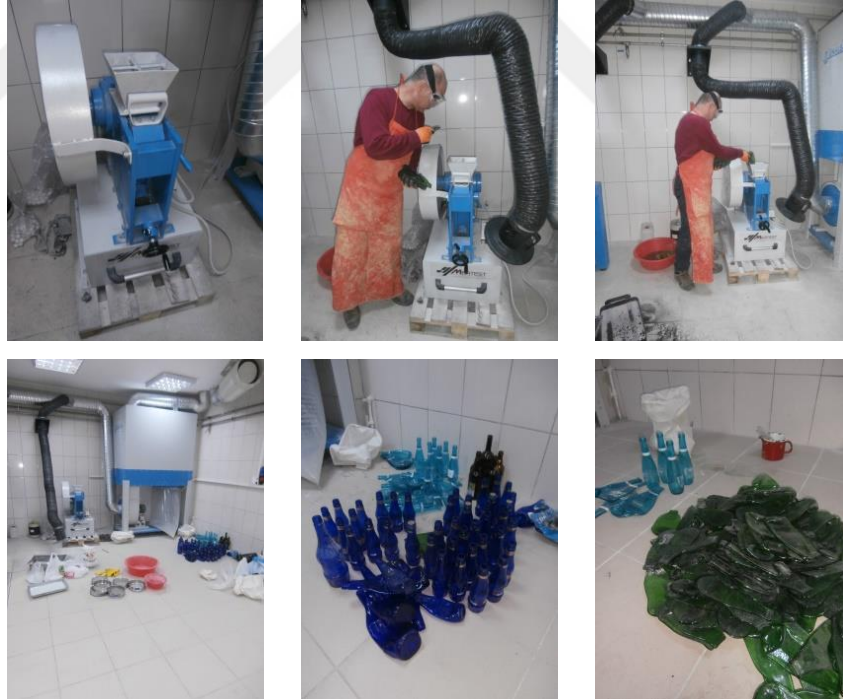
Görsel 129: Cevher kırma makinesi ve şişe kırma işlemi (Fotoğraflar Erkan Yersel)
