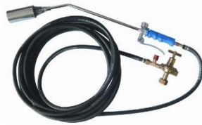
Görsel 35: Pürmüz ve Şaloma ya da oksijen kaynak takımı (Yalıtım, 2017)
