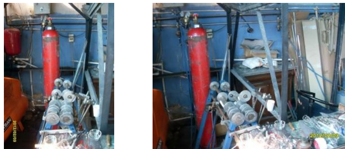
Görsel 38: Hidrojen, oksijen ve rulmanlar ile kesim Plaka grafit (Fotoğraf kişisel arşiv)
