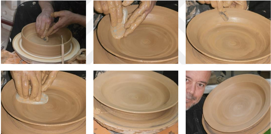
Görsel 93: Silindirden tabak yapılması ve perdahlanması, çap 35 cm. (Fotoğraf kişisel arşiv)
