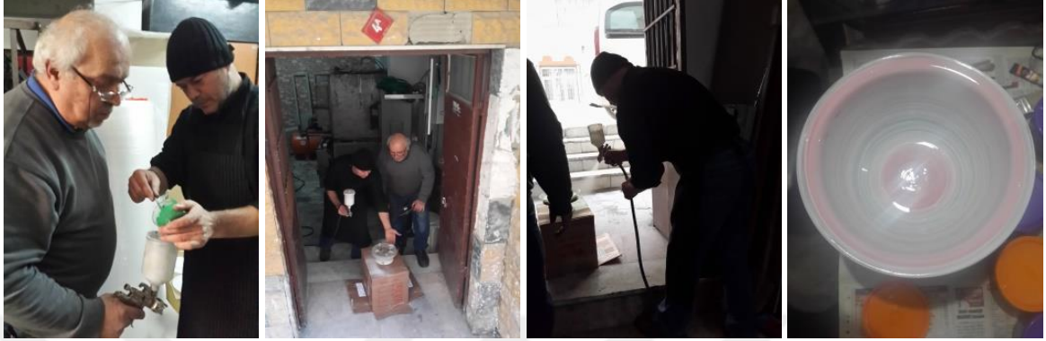
Görsel 63: Emay cam boyasının hazırlanması ve pistole ile boyanması (Fotoğraf kişisel arşiv)
