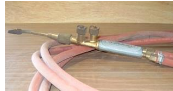
Görsel 35: Pürmüz ve Şaloma ya da oksijen kaynak takımı (Yalıtım, 2017)
