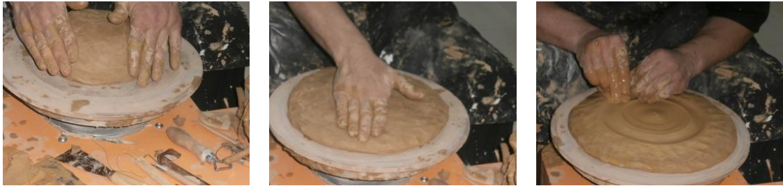
Görsel 91: Kilin yüzeye yayılması ve yüzeyin torna edilmesi (Fotoğraf kişisel arşiv)
