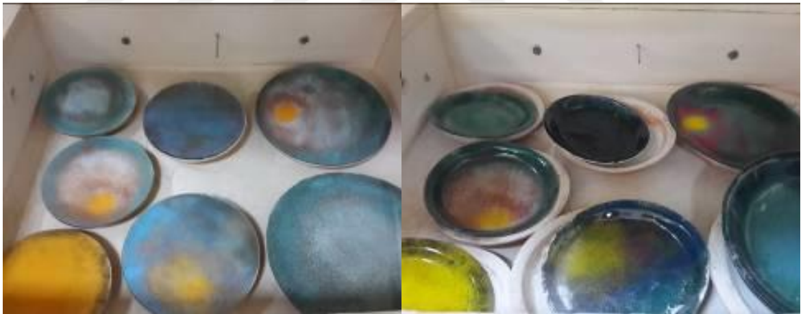
Görsel 120: Fırın öncesi dekorlanmış camlar ile fırın sonrası, altta toprak kalıplar (Fotoğraflar kişisel arşiv)
