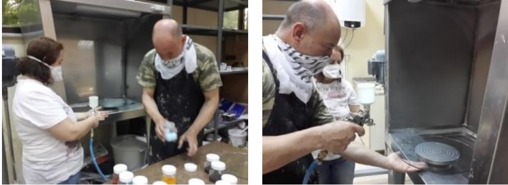
Görsel 118: Püskürtme yöntemi ile renklendirme (Fotoğraflar Serpil Aksüt)
