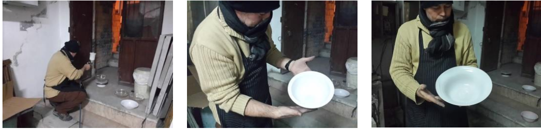
Görsel 65: Pistole ile cam tabakların boyanması (Fotoğraf kişisel arşiv)
