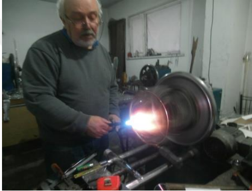
Görsel 59: Cam tabağın arka yüzeyinin çapaklardan temizlenmesi (Fotoğraf kişisel arşiv)
