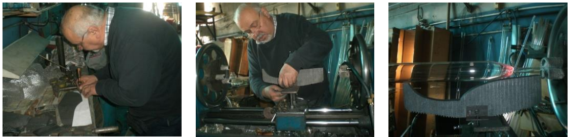
Görsel 70: Grafit kalıp hazırlığı ve tornaya takılması (Fotoğraf kişisel arşiv)
