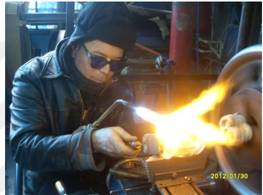
Görsel 80: E. Arda, cam tornasında şekillendirme (Fotoğraf kişisel arşiv)
