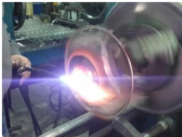
Görsel 60: Cam baget ile çapak temizleme işlemi (Fotoğraf kişisel arşiv)
