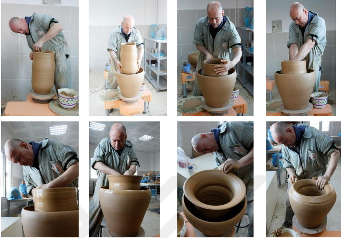
Görsel 102: Çarkta çift cidarlı üç boyutlu kil kalıp yapımı (Fotoğraf kişisel arşiv)
