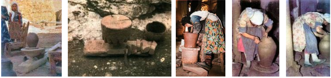
Görsel 18: Elle döndürülebilen çark. Turnetin alt tarafı ise ayakla çevirebilmek ve ittirebilmek için yontularak dişler açılmıştır (Güner, 1988), (Çarklı-Çömlekçiliğe-Geçiş, 2017)
