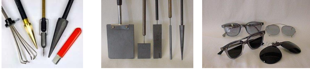
Görsel 37: Metal ve grafit el aletleri ile didmium gözlükler (Cam-malzeme, 2017)
