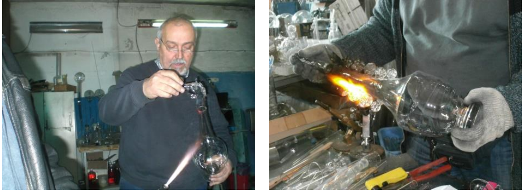
Görsel 76: Gövdeye at başı ve çiçek aksesuarlarının takılması (Fotoğraf kişisel arşiv)
