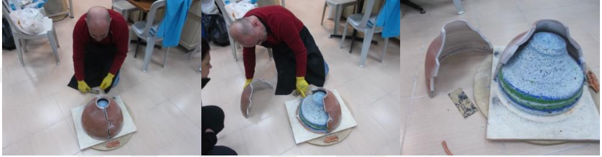
Görsel 137: Çift cidarlı kalıptan cam formun çıkarılması (Fotoğraf kişisel arşiv)
