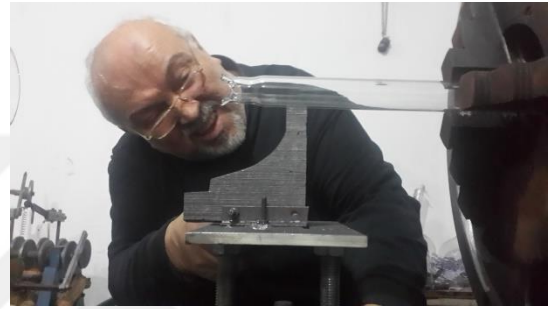
Görsel 47: Grafit kılavuz ile cam boru arasının ölçümü ve grafit ile cam boru mesafesinin ayarlanması (Fotoğraf kişisel arşiv)
