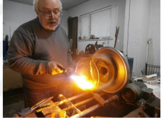
Görsel 59: Cam tabağın arka yüzeyinin çapaklardan temizlenmesi (Fotoğraf kişisel arşiv)
