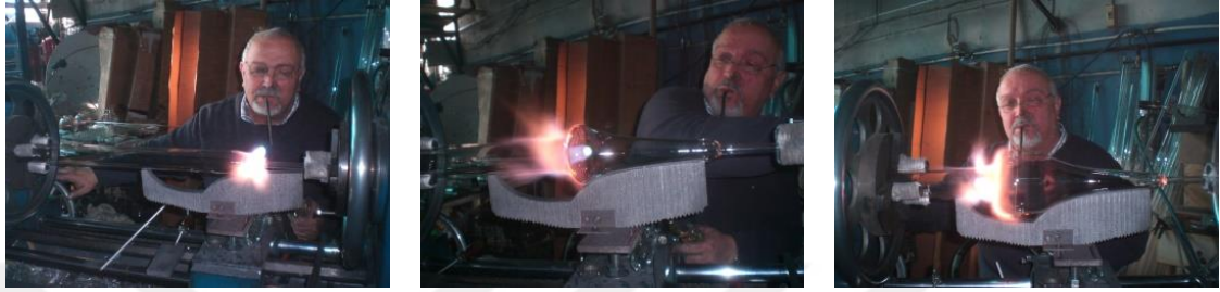
Görsel 71: At başlı testinin gövde yapım süreci (Fotoğraf kişisel arşiv)
