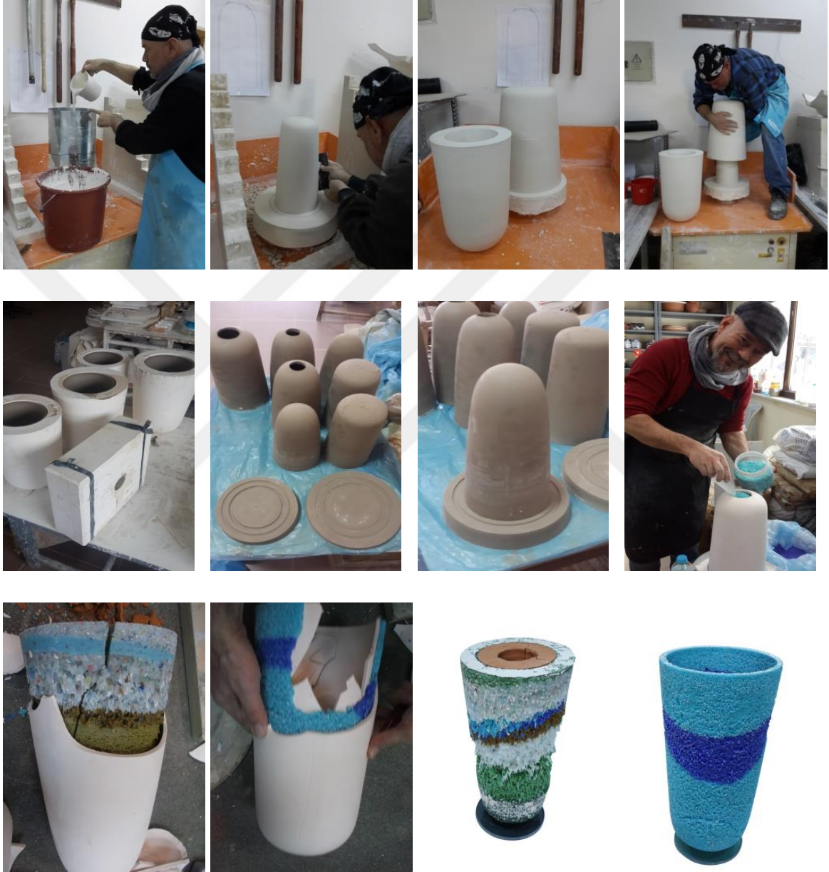
Görsel 141: Alçı tornada kalıp yapımı, döküm ve elde etme aşamaları
