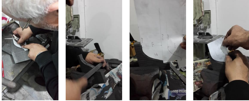
Görsel 45: Grafit şablona çizilmesi, kesilmesi ve eğelenmesi (Fotoğraf kişisel arşiv)
