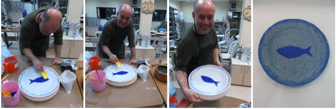
Görsel 136: Kenarlıklı çift cidar kalıp içine farklı boylardaki cam tanelerini yerleştirilmesi ve fırın sonrası örneği (Fotoğraflar Serpil Aksüt)
