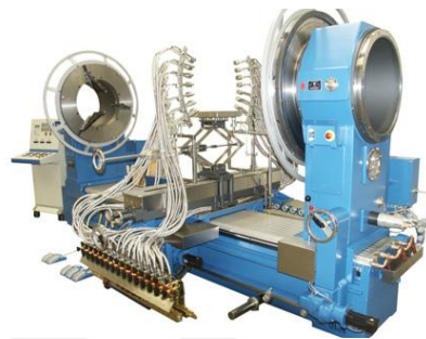
Görsel 31: Solda Halidun ustanın cam torna makinesi (Kişisel arşiv) Görsel 32: Sağda Cam Tornası (Practicalmachinist, 2017)
