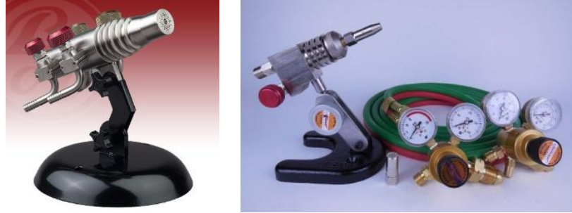
Görsel 36: Torch/Şalümo, detandör ve basınç ölçerler (Cam-malzeme, 2017)
