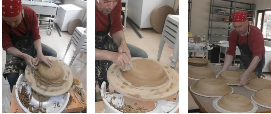
Görsel 107: Tabak kil kalıpların dip alma işlemi (Fotoğraf kişisel arşiv)
