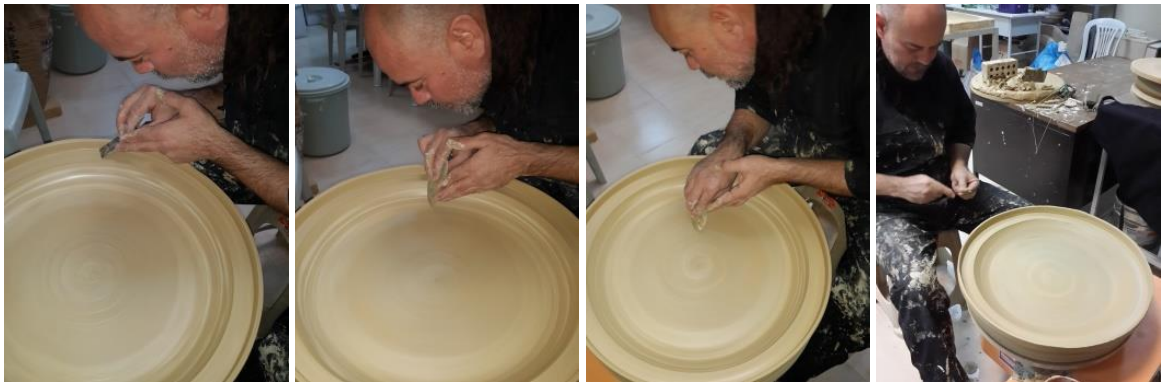
Görsel 98: Çift cidarlı tabak kalıbın yapılıma aşamaları (Fotoğraf kişisel arşiv)
