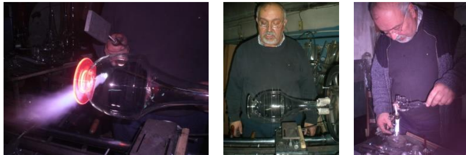
Görsel 75: Ayak takma işlemi ve at başının alevde şekillendirmesi (Fotoğraf kişisel arşiv)
