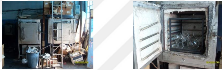
Görsel 39: Ağlass cam tansiyon fırınları ve fırın içi görünüm (Fotoğraf kişisel arşiv)
