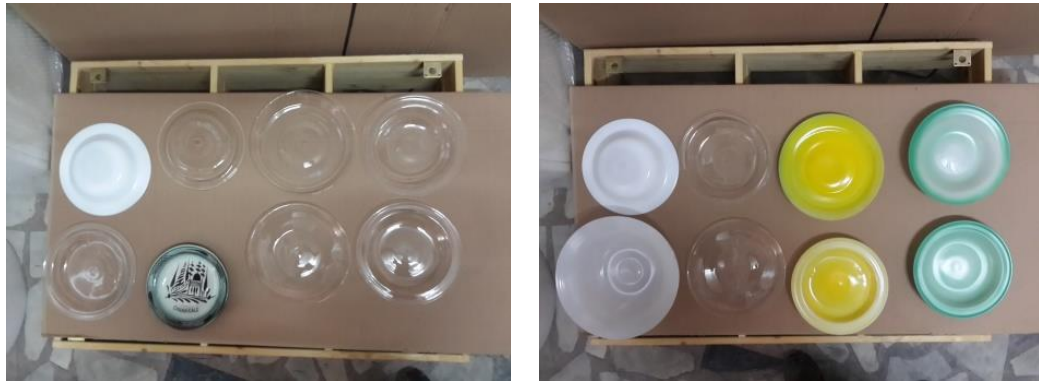
Görsel 64: Torna edilmiş tabaklar ve pistole ile boyanmış tabaklar (Fotoğraf kişisel arşiv)
