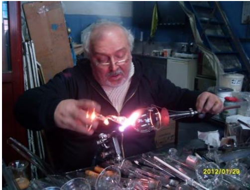
Görsel 81: Açık alevle şekillendirme ile kap ve sap kısımların montajı (Fotoğraf kişisel arşiv)
