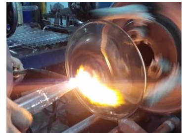
Görsel 60: Cam baget ile çapak temizleme işlemi (Fotoğraf kişisel arşiv)
