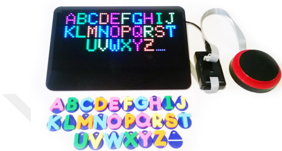
Görüntü 68: Somut platformun logo açılışından sonra ekrana alfabe harfleri gelmektedir. Ekran ile aynı renk kodlanmasına sahip somut harfler ve ekran görüntüleri.
