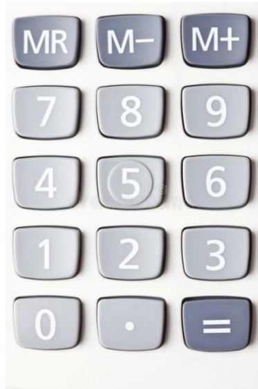
Görüntü 3: Hesap makinesi tuşları, 5 tuşuna kabartı eklenmiştir.
