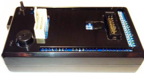
Görüntü 64: Arduino MEGA'nın kutulanmış hali.
