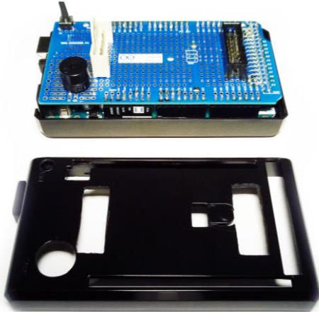
Görüntü 63: Arduino MEGA'nın kutulanma aşaması.
