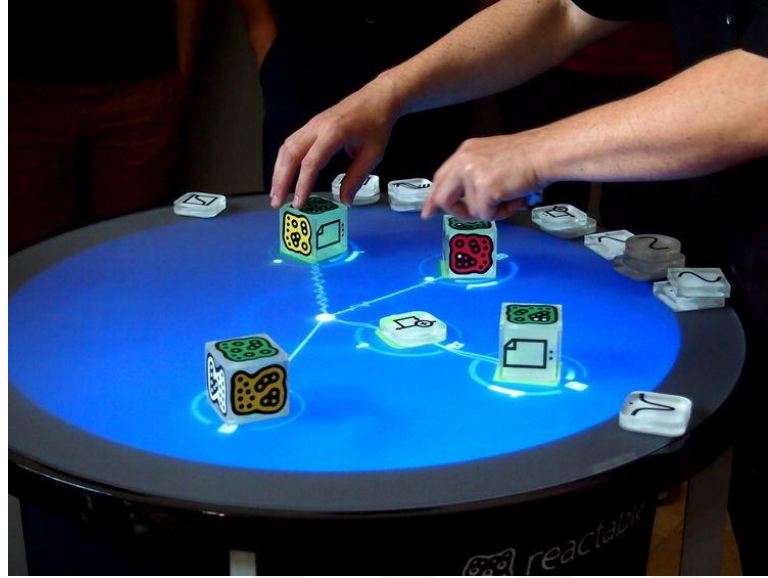
Görüntü 22 : Reactable, somut kullanıcı arayüzlü elektronik müzik aleti ( https://alchetron.com/Tangible-user-interface )
