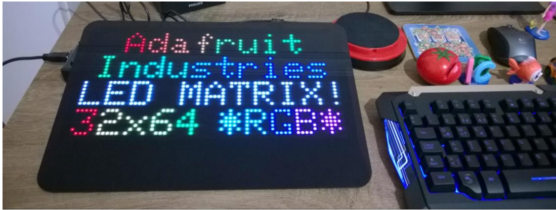
Görüntü 53: RGB 32X64 matrix ekran, koruyucu panel var, okunabilirlik yüksek.
