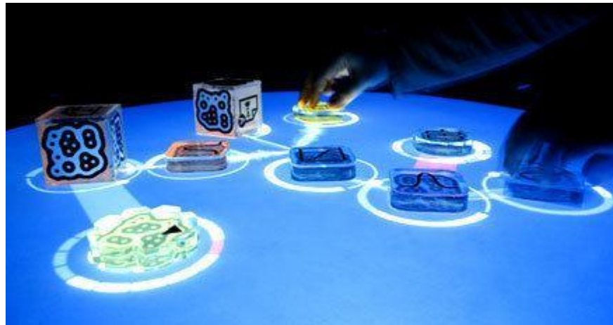
Görüntü 21 : Reactable, somut kullanıcı arayüzlü elektronik müzik aleti.
