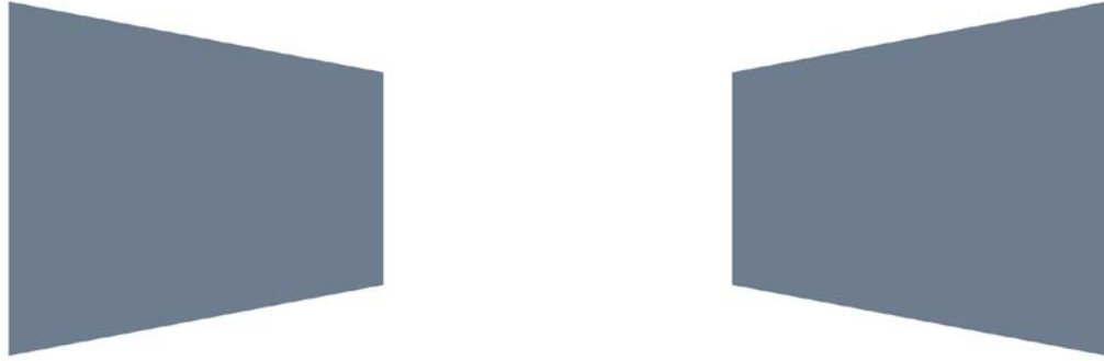
Görüntü 24 Yansıtıcı ve Görüntü Arasındaki Mesafenin Sırasıyla Sol ve Sağ Tarafa Kısa Olması Durumları ( http://smarttech.com/kb/~media/Images/Support%20document%20images/KB/SMARTBoards/133105-KeystoneErrorsHorizontal.ashx )
