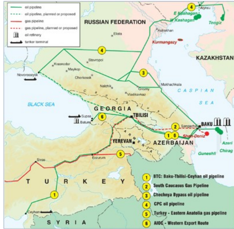
Şekil 12. Hazar Boru Hattı Konsorsiyumu (CPC) Boru Hattı 276
