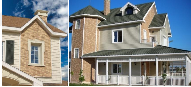
Resim 10. PVC Kaplama Uygulaması, Taş Görünüm ve Yalı Baskısı (URL-5, 2018).
