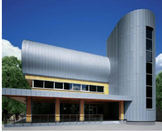
Resim 8. Çinko Kaplama Kenet Sistem, Entertainment Centre,Lviv, Ukrayna (URL-3, 2018).
