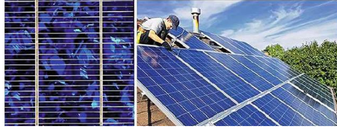
Resim 90. Tek Bir Polikristalin Silikon PV Hücresi: Hücre ızgara hatlarını ve çoklu kristalleri gösterir (solda) ve bir ev çatısına birkaç modül yerleştirilmesi (sağda) (Fraas, 2014).
