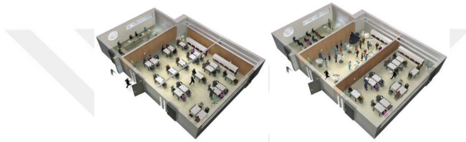
Resm 16. Hareketli Hazır Panel Bölme Elemanları(Cengiz, 2008).
