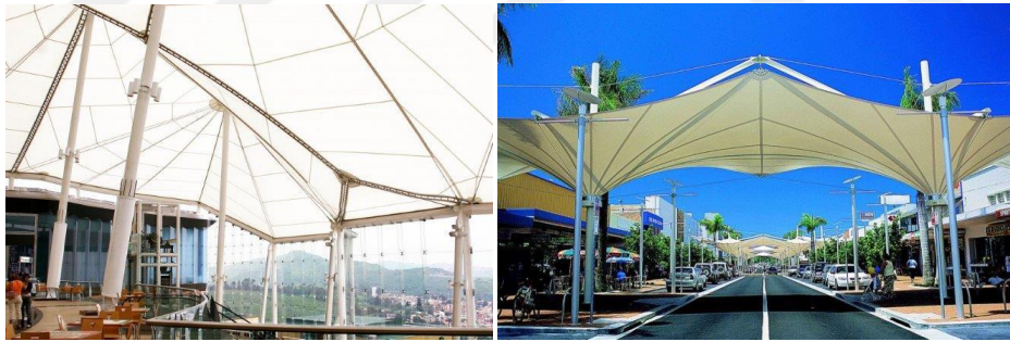
Resim 45. Taiyo Teknoloji Uygulamaları: TiO2 ile çeşitli yapı membranları. a)Lomas Verde Shopping Mall, Meksika (PTFE) b) Coffs Harbour Mall, Avustralya (PTFE)(URL-24).
