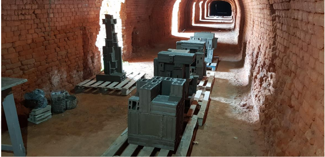
Resim 111. Plastik ham oluklu tuğladan oluşturulmuş, beş farklı parçanın bir araya gelmesiyle oluşturulması planlanan dört metrelik form örneği (Suçağlar, Kişisel arşiv)
