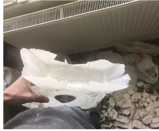
Fotoğraf 49. Kalıp içerisine konulan camın yetersiz gelmesinden kaynaklı boşluk, üst görünüm (Resul Güney 2018)
