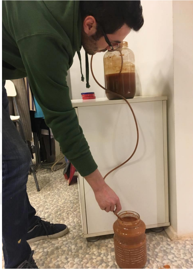
Resim 15: Sifon yöntemi ile Terra Sigillata astarının başka bir kaba alınması
