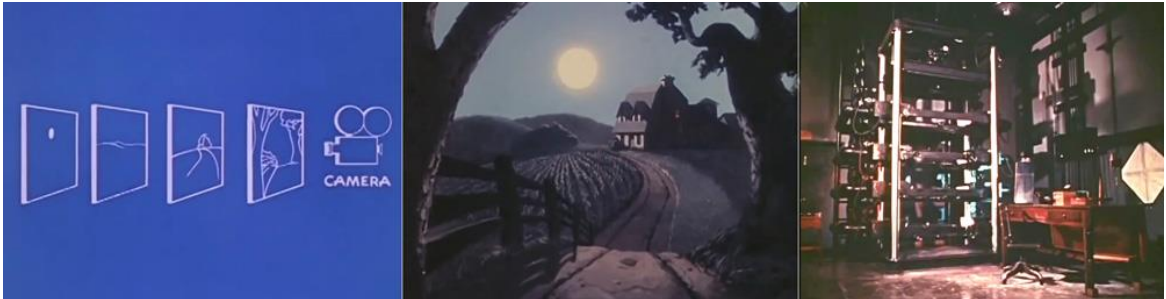
Görsel 112. Solda çoklu-plan kamerasını çalışma prensibi, ortada bahsi geçen sahne, en sağda ise kameranın fiziksel görünümü (Disney, 1957).
