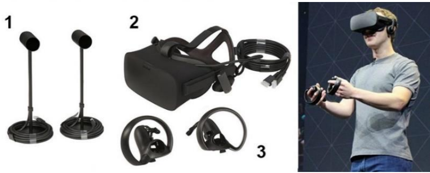
Görsel 97. Oculus VR Gözlük seti: 1. Cihazın sensörleri, 2. Kafaya takılan gözlük seti, 3. kumandalar (Oculus Blog, 2019) Erişim: 26.01.2019
