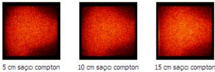
Şekil 4.14 Kaynak-detektör arası mesafe yokken Compton penceresinde farklı saçıcı kalınlıklarında alınan karaciğer fantomu görüntüleri
