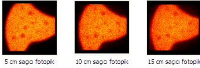
Şekil 4.16 Kaynak-detektör arası mesafe 15,5cm'de sabitlenmişken Fotopik penceresinde farklı saçıcı kalınlıklarında alınan karaciğer fantomu görüntüleri
