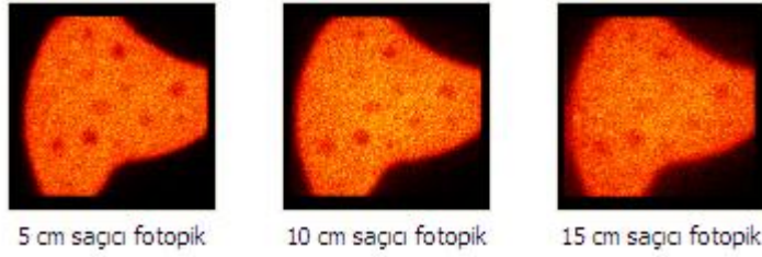
Şekil 4.13 Kaynak-detektör arası mesafe yokken Fotopik penceresinde farklı saçıcı kalınlıklarında alınan karaciğer fantomu görüntüleri
