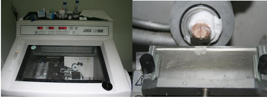
ekil 15 : Leica marka mikrotom cihazı, doku kesitlerinin alınması
