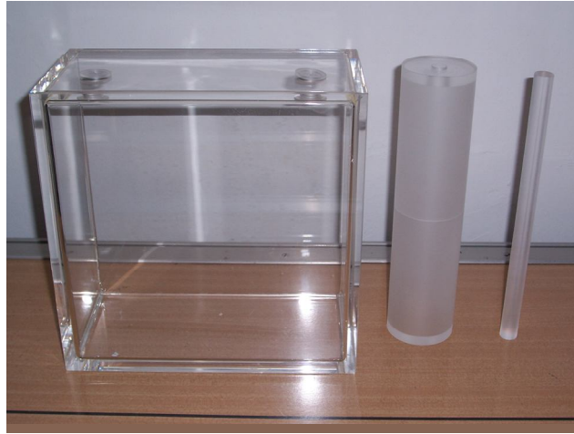
Şekil 2.38 ISO kişisel dozimetre kalibrasyon fantomları
