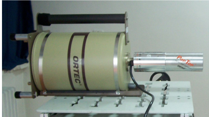
Şekil 2.18 Yüksek saflıkta germanyum yarı iletken dedektör
