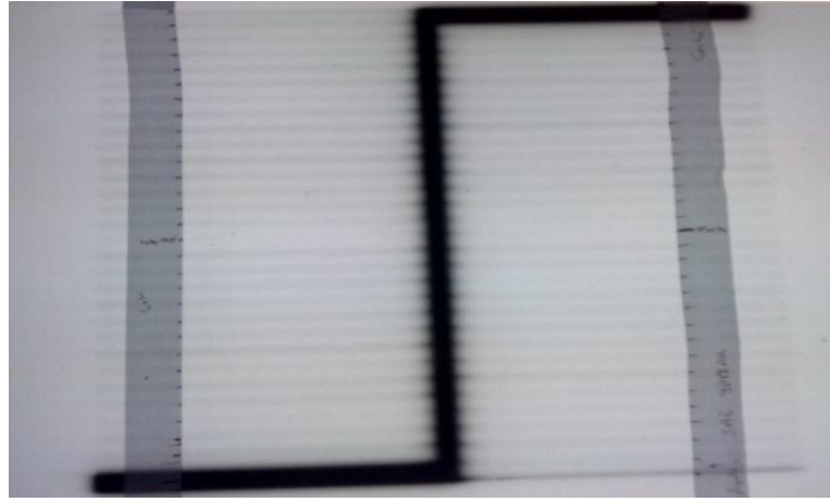
Şekil 4.3 Sızıntı ve geçirgenlik testi için ışınlanmış filmin görüntüsü
