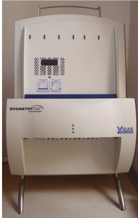
Şekil 3.9 Vidar Marka DosimetryPRO Advantage Film Tarayıcısı
