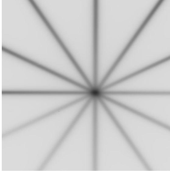
Şekil 4.3 Lineer hızlandırıcı kalite kontrol testlerinden kolimatör dönüşü ile eşmerkez değişimi testi için Elekta marka lineer hızlandırıcıda ışınlanmış filmin görüntüsü
