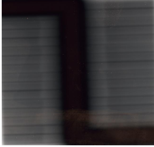
Şekil 4.11 ÇYK sızıntı ve geçirgenlik testinde Elekta marka lineer hızlandırıcı cihazında ışınlanmış filmin görüntüsü
