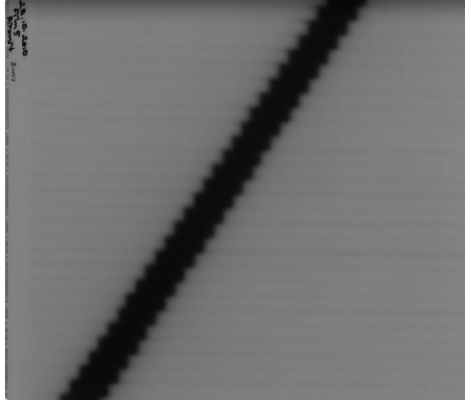
Şekil 4.9 ÇYK pozisyon doğruluğu testinde Elekta marka lineer hızlandırıcı cihazında ışınlanmış filmin görüntüsü
