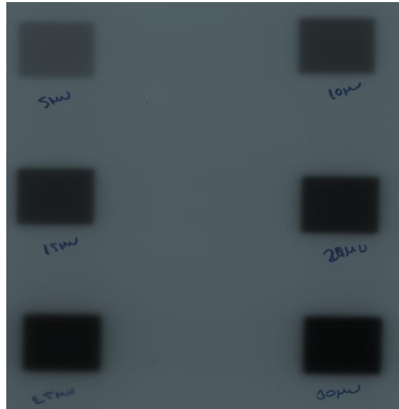
Şekil 4.8 Varian marka lineer hızlandırıcıda ışınlanmış kalibrasyon filmi görüntüsü
