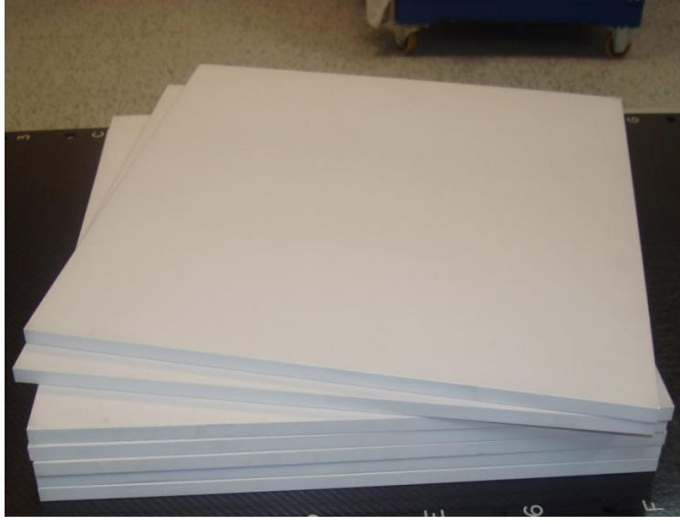
Şekil 3.5 Scanditronix Wellhöfer Marka RW3 Katı Su Fantomu
