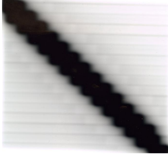
Şekil 4.10 ÇYK pozisyon doğruluğu testinde Varian marka lineer hızlandırıcı cihazında ışınlanmış filmin görüntüsü
