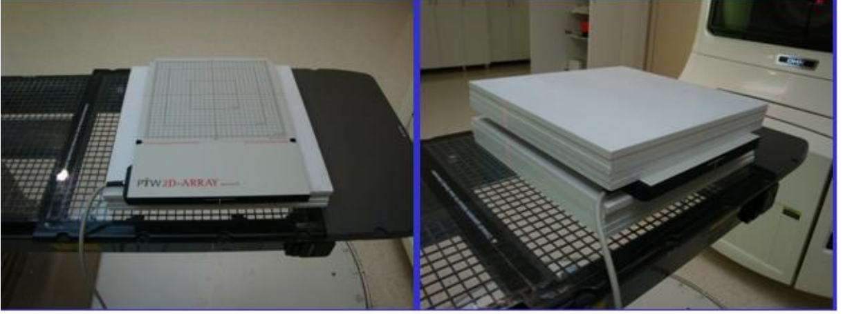
Şekil 3.6 Seven 29 / 2D Array ve Sandviç Set – up Gösterimi
