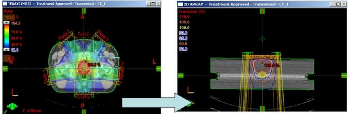
Şekil 3.11 Tedavi Planının Seven 29 / 2D Array 2 Boyutlu İyon Odasına Aktarılması
