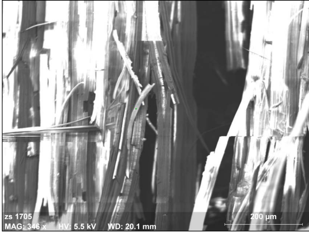
Şekil 1.1 İğne (5.4) minerale ait geri saçılmış detektörü (BSD) ile alınmış SEM görüntüsü, yeşil noktadan)X-ışını analizi yapılmıştır.
