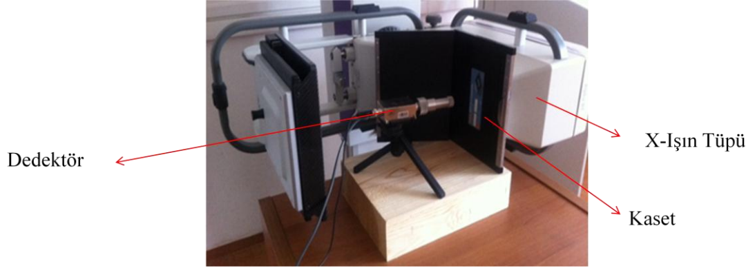
Şekil 3.8 Ekranlardan çıkan x-ışınlarının toplandığı geometri
