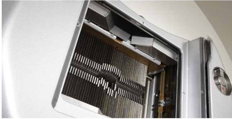
Şekil 3.2 Siemens ARTISTE lineer hızlandırıcı cihazının çok yapraklı kolimatör sistemi
