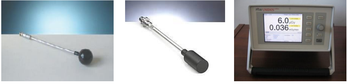
(a) küresel iyon odası 28 cm 3 (b) Silindirik iyon odası 30 cm 3 (c) Elektrometre Şekil 3.2 Doz ve doz hızı ölçümünde kullanılan referans iyon odaları ile iyon odası elektrometresi
