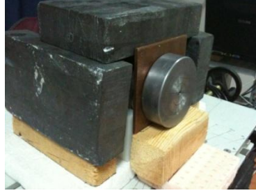
Şekil 3.7 BC-408 PS dedektörün zırhlaması
