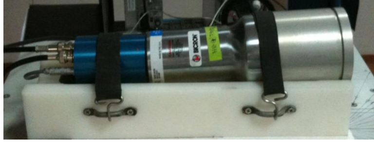
Şekil 3.4 Deneyde kullanılan Bicorn marka BC-408 plastik sintilatörlü dedektörün fotoğrafı
