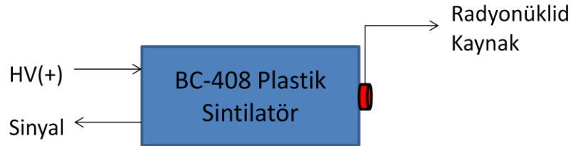
Şekil 3.12 Radyonüklid kaynaklar kullanılarak spektrumların toplanması için kurulan geometri
