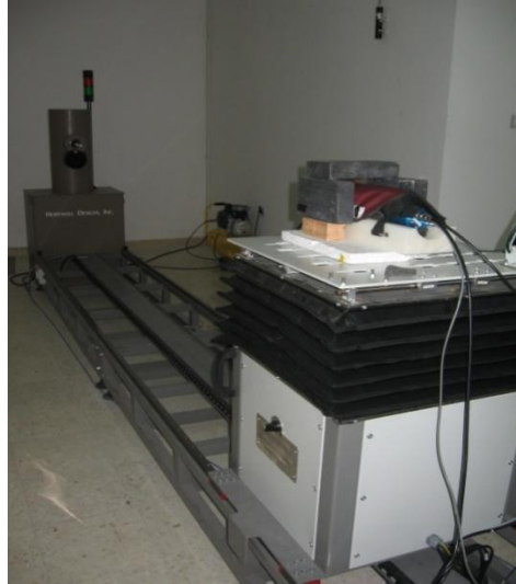
Şekil 3.1 ^{137}\text{Cs} ışınlama ve ölçmeleri için mobil 3D- radyometrik benç fotoğrafı
