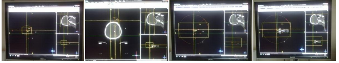
Şekil 4. 54: Prowess Panther planlama sisteminde 7,5 cm x 10 cm ve 15 cm x 30 cm alanlarının diverjans doğrulaması (SSD = 103 cm)
