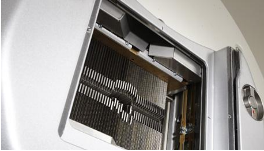
Şekil 3.2 Siemens marka Artiste model lineer hızlandırıcıya ait ÇYK' ların üstten görünümü
