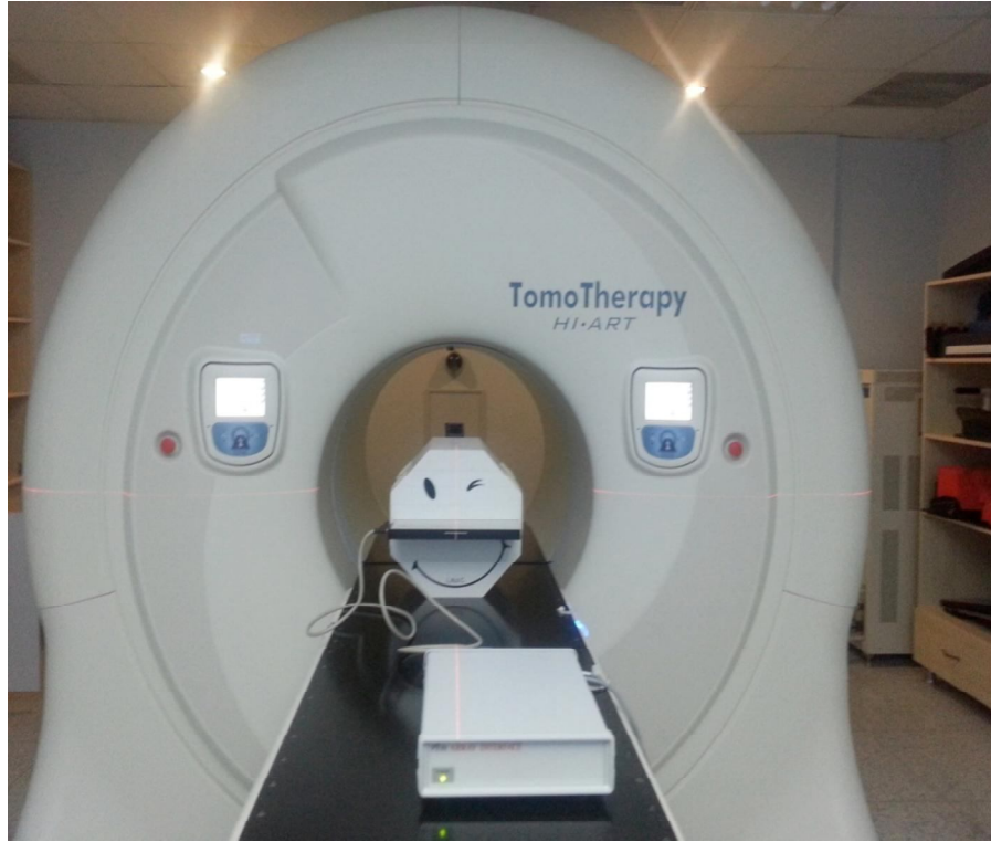
Şekil 3.7 Octavius fantom ve Seven-29 2D array ile doz doğrulanması
