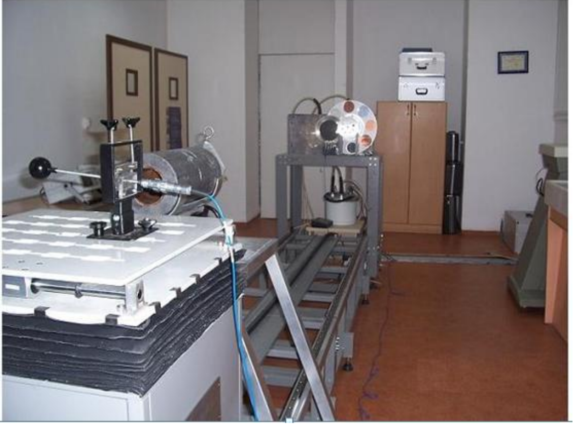
Şekil 3.2 X-ışın kalibrasyon sistemi
