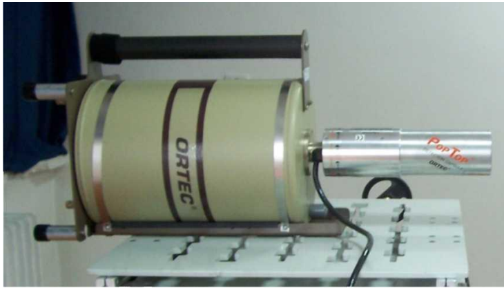
Şekil 2.19 Yüksek saflıkta germanyum (HPGe) yarıiletken dedektör
