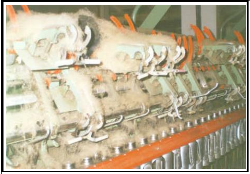
Resim 3.2. Eğirme (Vater) makinesi üzerinde biriken jüt tozları
