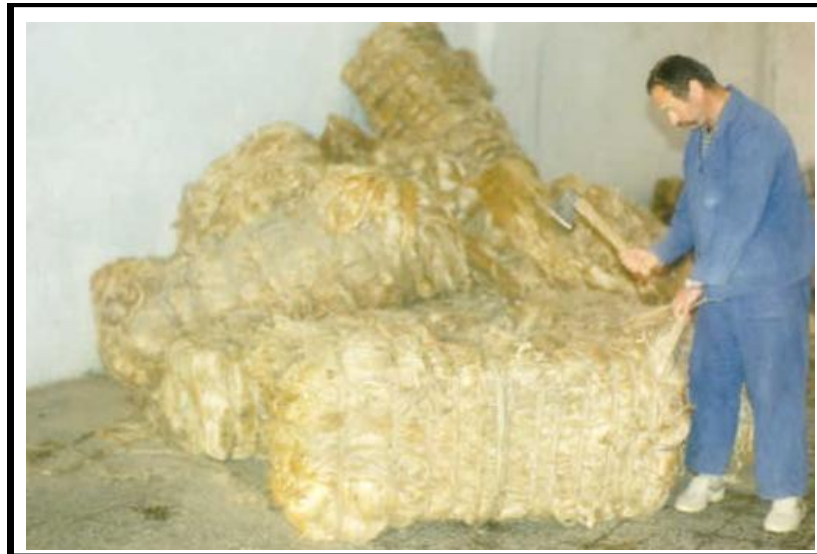
Resim 3.4. Jüt balyalarının açılması
