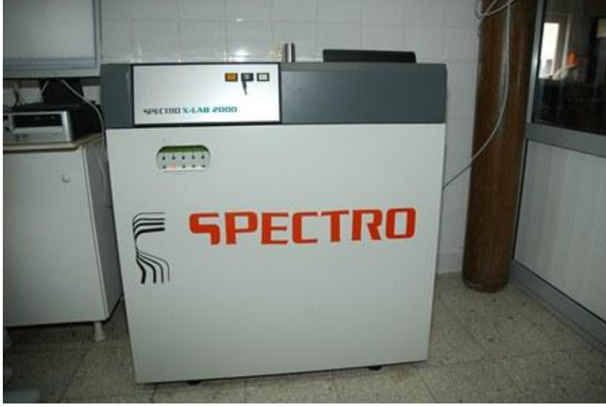
Şekil 2.8. 1 Ankara Üniversitesi Mühendislik Fakültesi Jeoloji Mühendisliği Bölümü Petrografi Uygulama ve Araştırma Laboratuvarındaki X-ışınları Floresans (XRF) spektroskopi cihazı.
