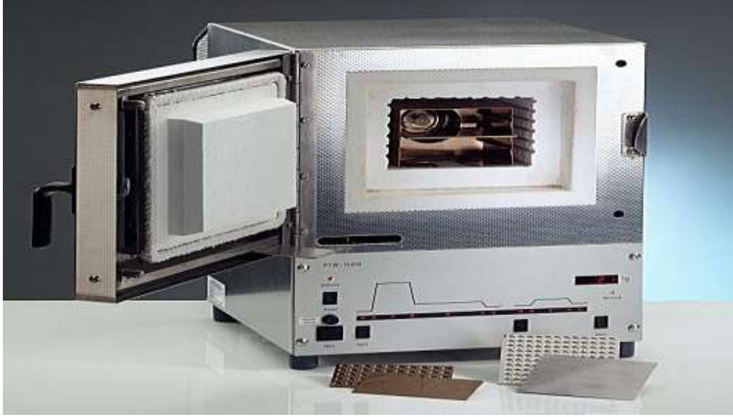
Şekil 3.2 PTW-TLDO TLD tavlama fırını
