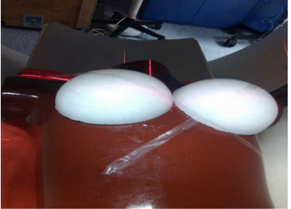
Şekil 3.9 Parafinin toraks fantomuna yapıştırılmış gösterimi
