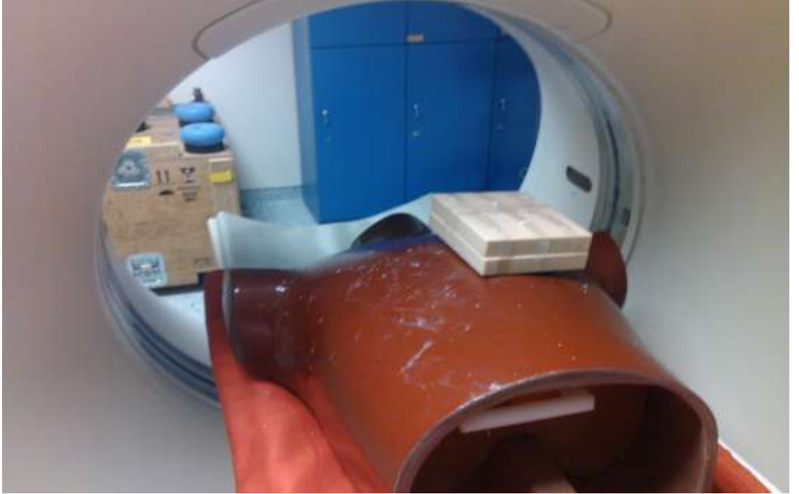
Şekil 3.8 Meme test tabakalarının toraks fantomuna yapıştırılmış hali
