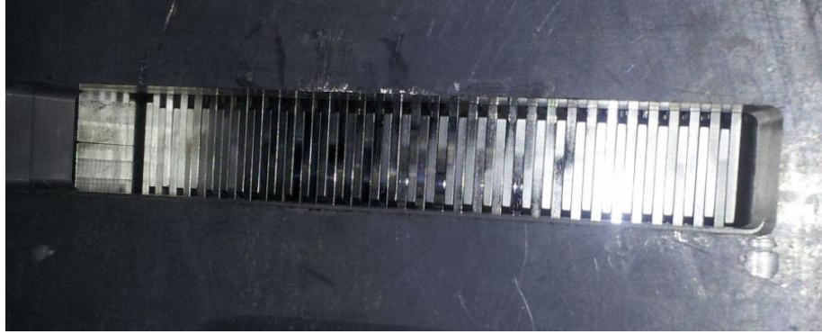
Şekil 10. Tomoterapi Hi-Art ikili MLC'leri (binary MLC) .
