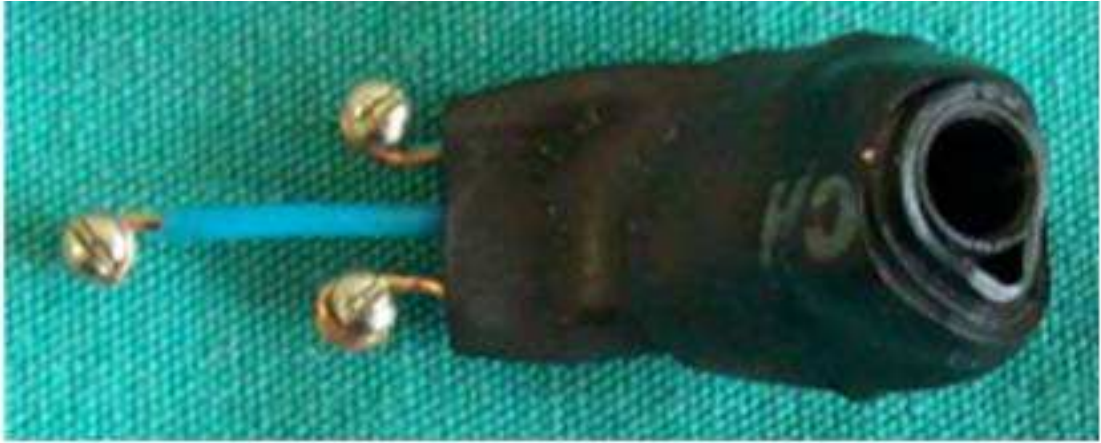
Şekil 6. Kafatasına yerleştirilen vida elektrotlar
