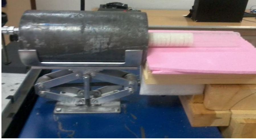
Şekil 4.19 Numuneler için zayıflatma özelliklerinin belirlenmesinde kullanılan düzenek
