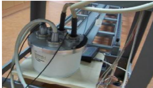
b) GiCi model 2000 yüksek gerilim bölücü (150 kV p X-ışını tüp jeneratörüne bağlantılandırılmış resmi)
