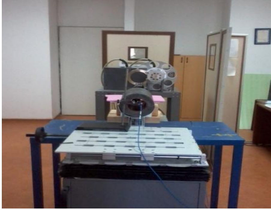
Şekil 4.15 Dar demet, geniş demet karşılaştırma için kurulan düzenek
