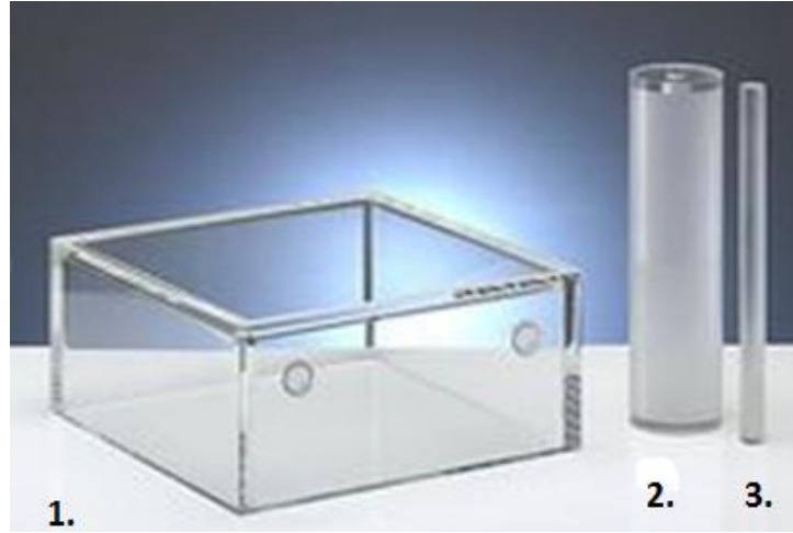
Şekil 3.3 ISO fantomları (1. Su dilim fantom, 2. Su sütun fantom, 3. PMMA çubuk fantom)
