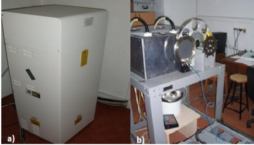
Şekil 2.1 a) Yüksek frekans jeneratörü b) Kurşun zırh içerisindeki X-ışını tüpü ve bağlantıları
