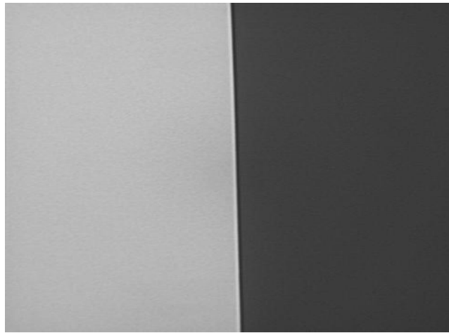
Şekil 2.9 MTF hesaplamasında kullanılan kenar fantomu görüntüsü
