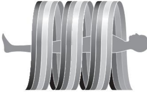
Şekil 2.15 Çoklu Kesit Helikal BT Sistemi [36]
