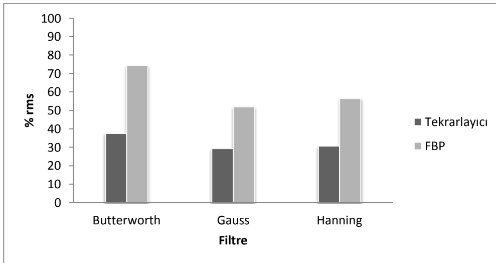
Şekil 4.5 Jaszczak fantomu, farklı filtre ve kesit elde etme yöntemleri için hesaplanan % rms sonuçları (düzeltmeli, tekrar sayısı: 6, altgrup sayısı (subset):16, kesim frekansı: 0.7, büyütme faktörü (zoom): 2)
