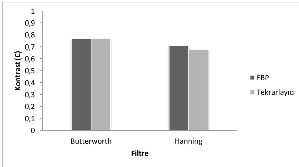
Şekil 4.58 Jaszczak fantomu, farklı filtre ve kesit elde etme yöntemleri için hesaplanan kontrast sonuçları (düzeltilmeli, tekrar sayısı: 6, altgrup sayısı (subset):16, kesim frekansı: 0.7, lezyon çapı: 31.8 mm, büyütme faktörü (zoom): 1.5)
