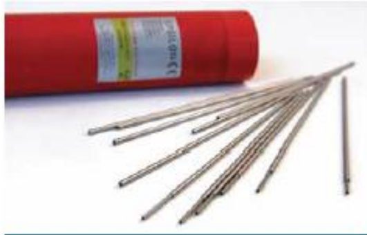
Şekil 3.5 ^{68}\text{Ge} çubuk kaynak fantomu
