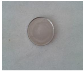
Şekil 3.4 Orantılı sayaçta ölçülmek üzere paslanmaz çelik planşet içinde hazırlanmış su numunesi.
