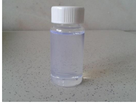
Şekil 3.5 LSC’de ölçülmek üzere cam vialde hazırlanmış su numunesi.
