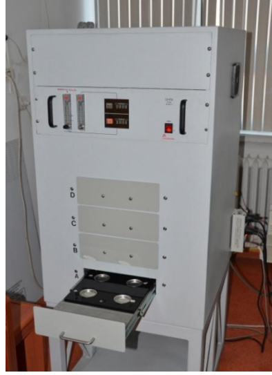
Şekil 3.6 Canberra LB4110 Düşük Seviye Alfa ve Beta Sayım Sistemi
