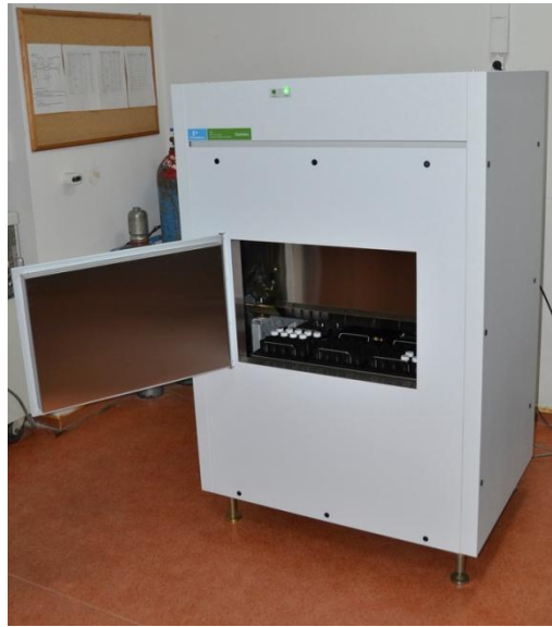
Şekil 3.7. Quantulus 1220 Ultra Düşük Seviye Sıvı Sintilasyon Sayım Sistemi
