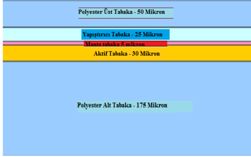
Şekil 2.12 Gafkromik EBT 2 filmin fiziksel yapısı
