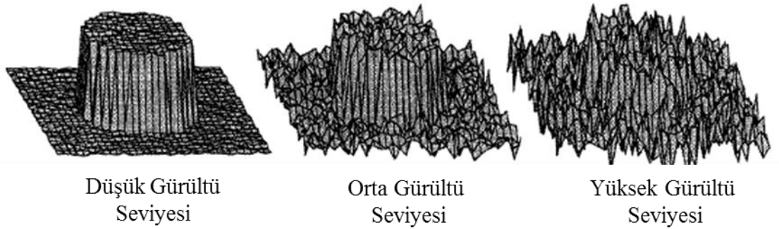
Şekil 2.11 Gürültünün obje dedeksiyonuna olan etkisini gösteren görüntü. Görüntülenmek isteyen obje artan gürültü miktarı ile gürültü arasında kaybolmaktadır (Bushberg vd 2003'ten değiştirilmiştir)
