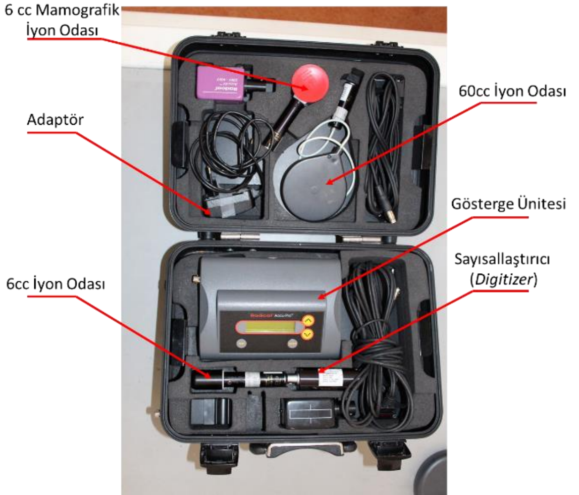
Şekil 3.1 Kullanılan Radcal marka dozimetrik sistem seti.
