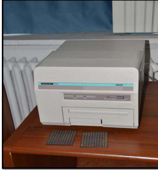
Şekil 3.9 Harshaw marka 3500 model TLD okuyucu
