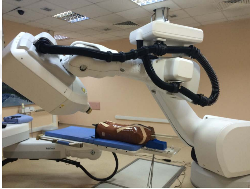
Şekil 3.5 Cyberknife Robotik Lineer Hızlandırıcı Cihazı
