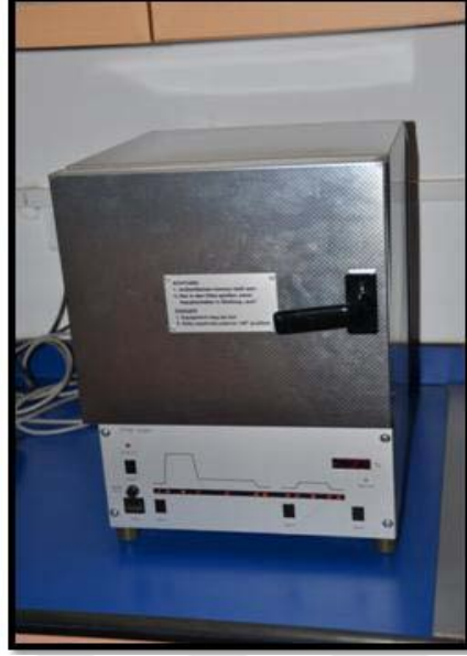
Şekil 3.10 PTW marka TLD 3500 model TLD fırını
