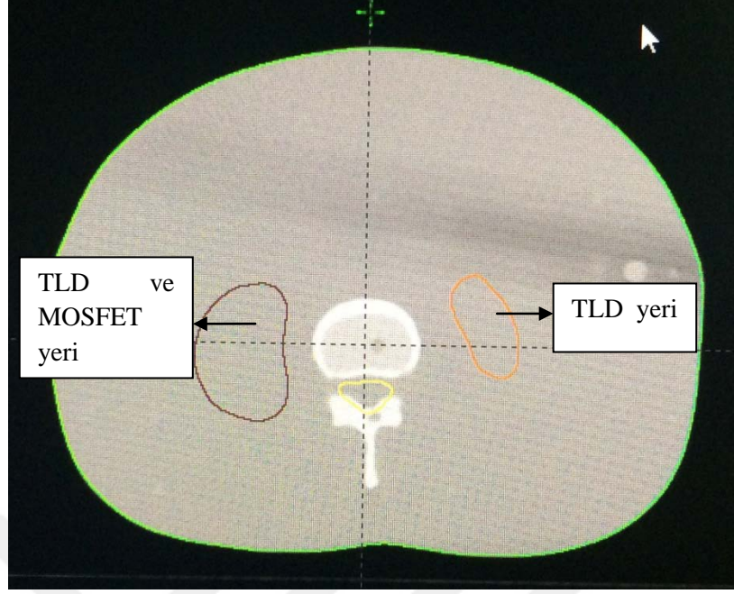
Şekil 3.23 Rando fantomun 25. kesiti ve dozimetre yerleri (sağ ve sol böbrekler)
