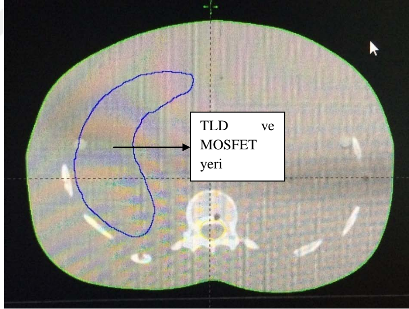
Şekil 3.20 Rando fantomun 21. kesiti ve dozimetre yeri (karaciğer merkezi)
