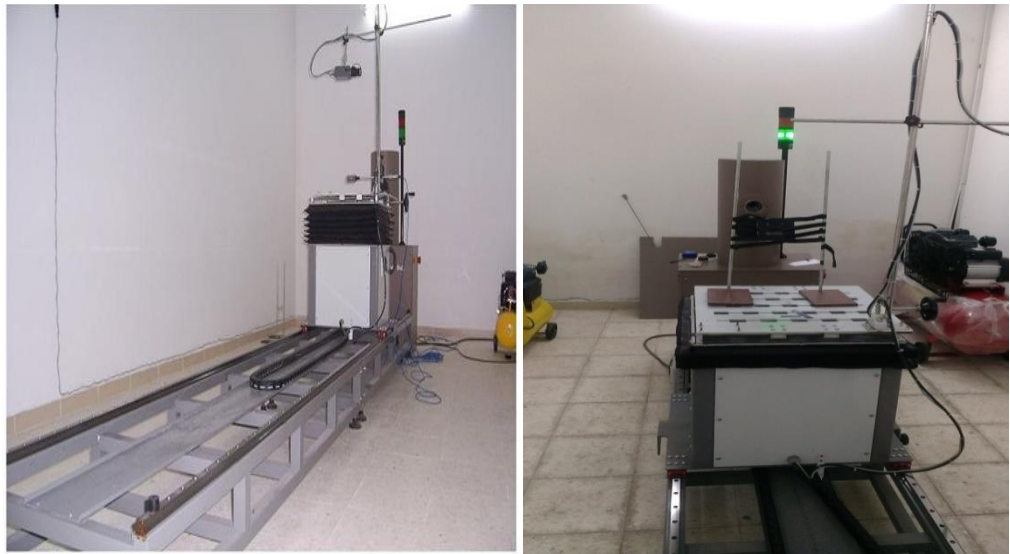
Şekil 3.2.4.1 Ankara Üniversitesi Nükleer Bilimler Enstitüsü'nde bulunan 137 Cs gama kaynağı ışınlama sistemi
