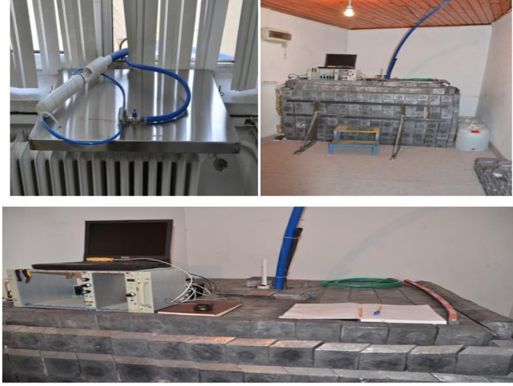
Şekil 3.2.3.1 37 GBq 241 Am-Be nötron ışınlama ünitesi
